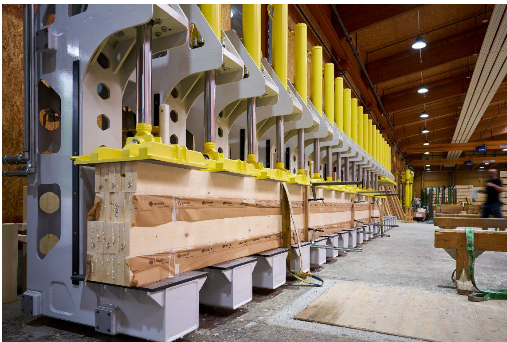
Figure 105: Pressage d'un élément en bois lamellé-collé en bloc. (source: Roth Burgdorf AG)
