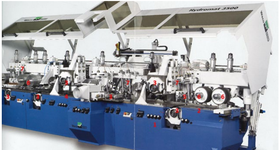
Abbildung 51: Mehrseitenhobelmaschine mit neun Spindeln, Einzug rechts (Quelle: Weinig)
