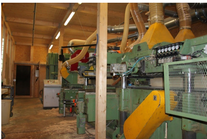
Figure 101: Rabotage d'un élément de construction dans une raboteuse quatre faces (source: Roth Burgdorf AG)
