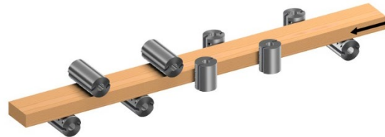
Abbildung 57: Anordnung 6 mit 9 Spindeln, unten-rechts-links-rechts-links-oben-unten-oben-unten (Quelle: Weinig)
