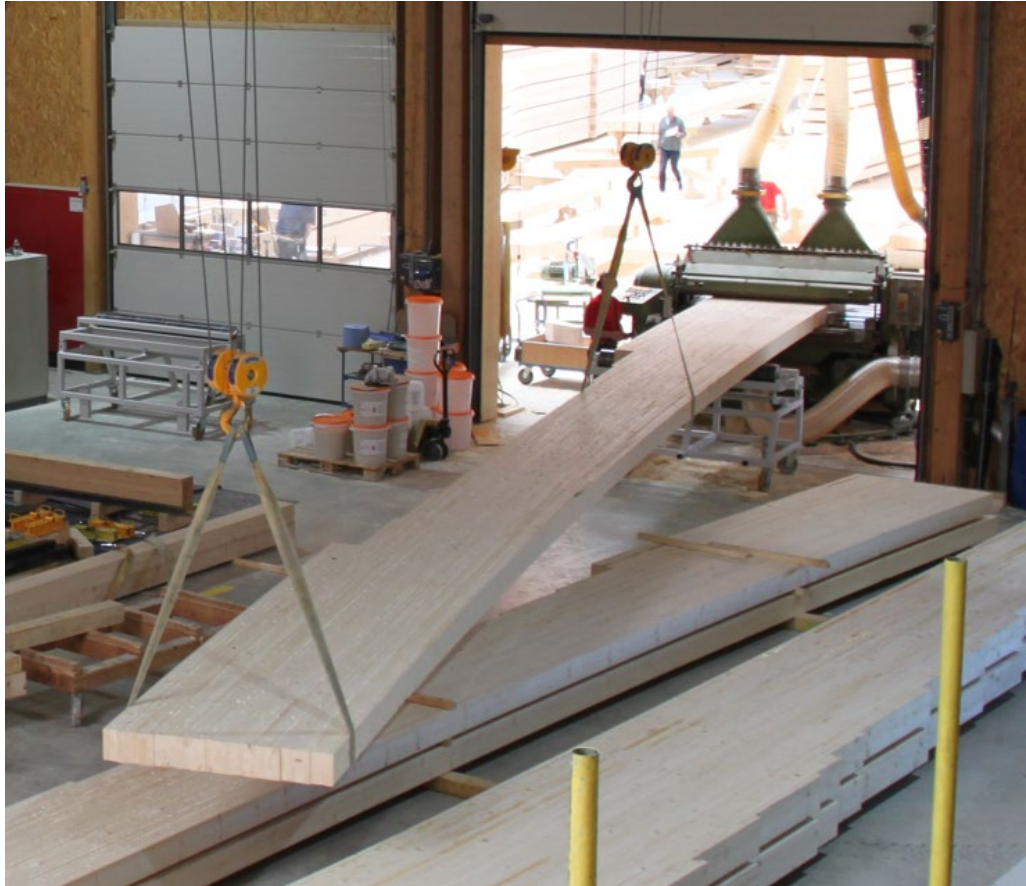
Abbildung 100: Hobeln eines gekrümmten Bauteiles in einer drehbar gelagerten Dickenhobelmaschine. (Quelle: Roth Burgdorf AG)
