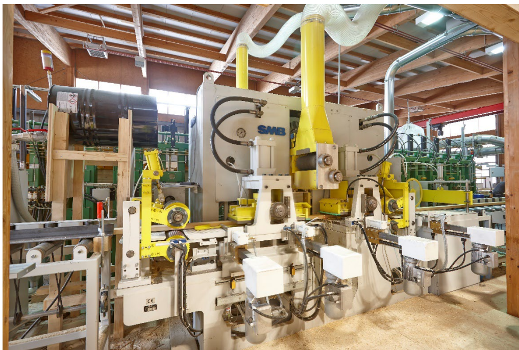
Figure 84: Installation d'aboutage (source: R. Näf)
