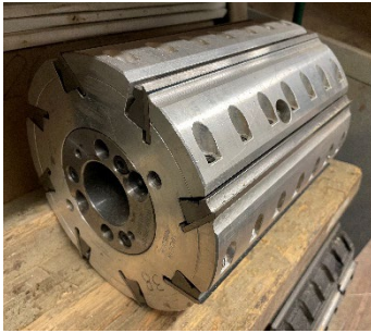
Abbildung 59: Hobelkopf (Hydrowerkzeug) für untere Abrichtwelle mit klassischem Hobelmesser (Quelle: OLWO AG)
