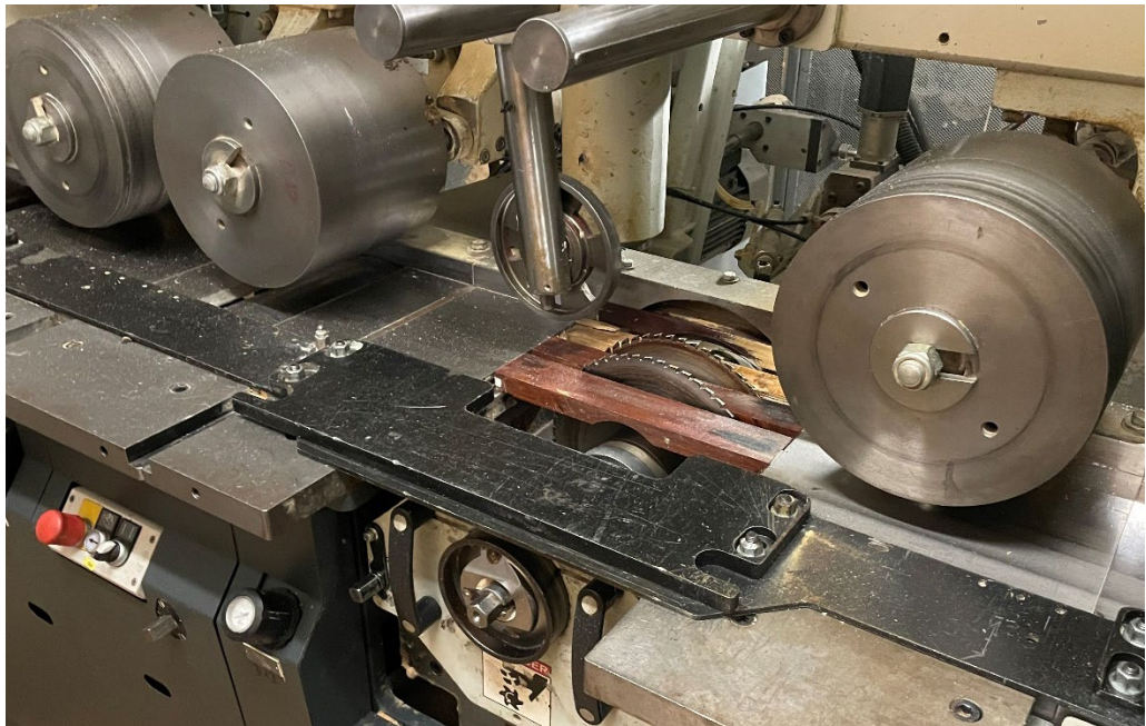
Abbildung 61: Auftrennen mittels Hobelmaschine (Quelle: OLWO AG)
