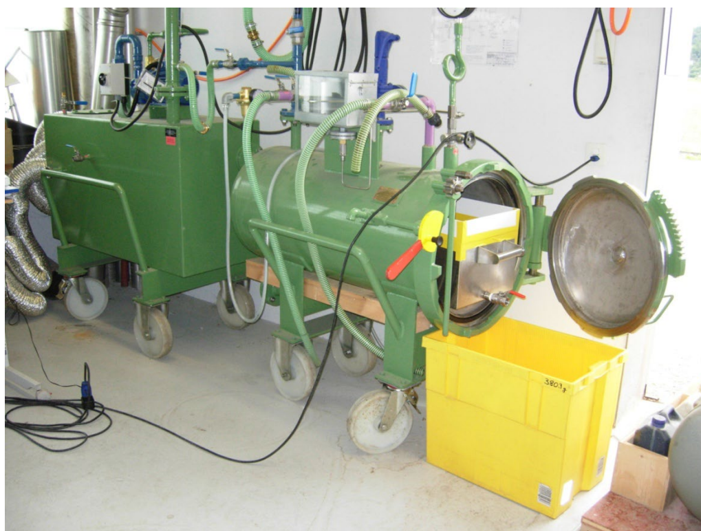
Figure 98: Dispositif pour l'essai de délamination. (source: M. Lehmann, BFH-AHB)
