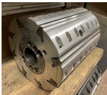
Figure 59: Tête de rabotage (outil hydraulique) pour l'arbre de dégauchissage inférieur avec des lames de rabot classiques. (source: OLWO AG)
