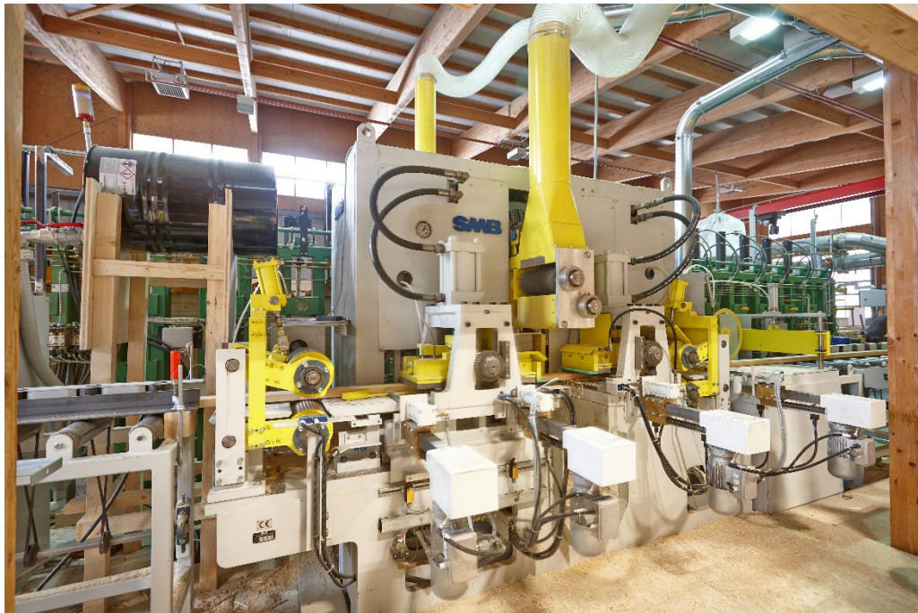
Abbildung 84: Keilzinkenanlage (Quelle: R. Näf)
