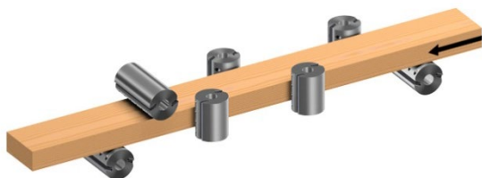
Figure 54: Disposition 3 avec 7 broches: en bas – à droite – à gauche – à droite – à gauche – en haut – en bas (source: Weinig)
