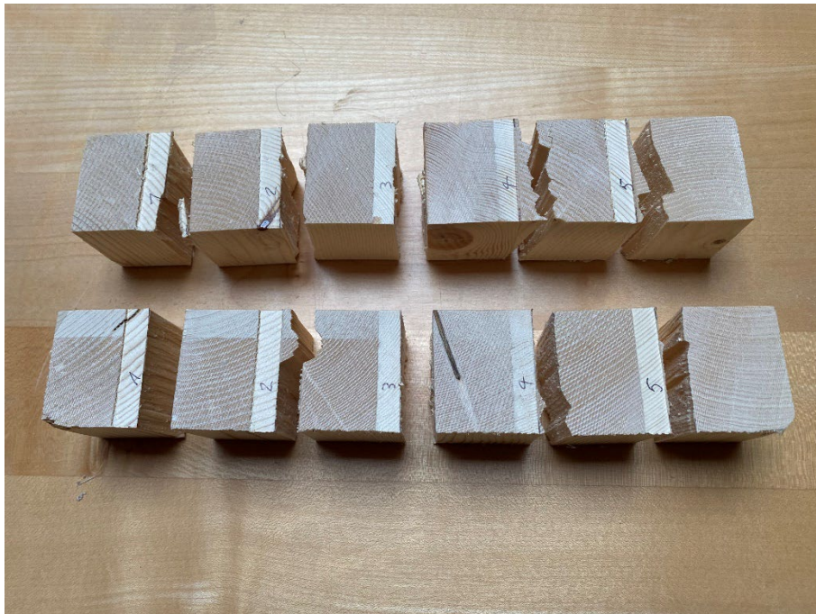
Abbildung 97: Entnommene Proben für die Delaminierungsprüfung. (Quelle: Roth Burgdorf AG)
