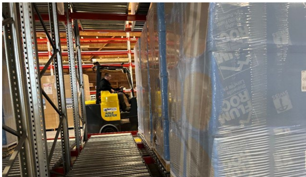
Abbildung 31: Durchschubregal (Quelle: OLWO AG)
