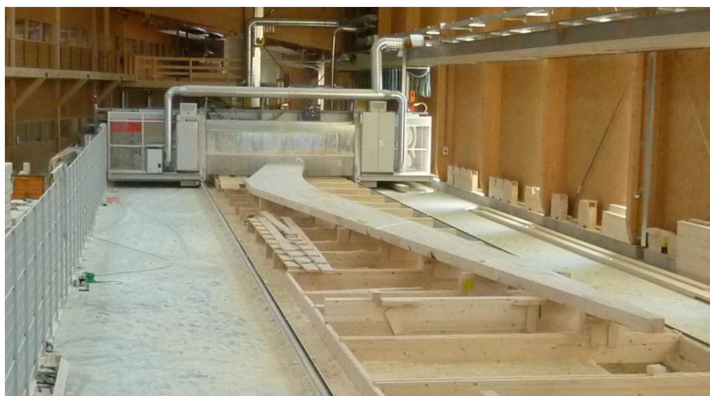
Figure 102: Taillage d'une poutre cintrée en lamellé-collé pour un toit à deux pans. (source: Roth Burgdorf AG)
