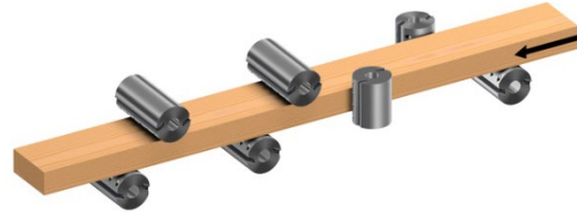
Abbildung 55: Anordnung 4 mit 7 Spindeln, unten-links-rechts-oben-unten-oben-unten (Quelle: Weinig)
