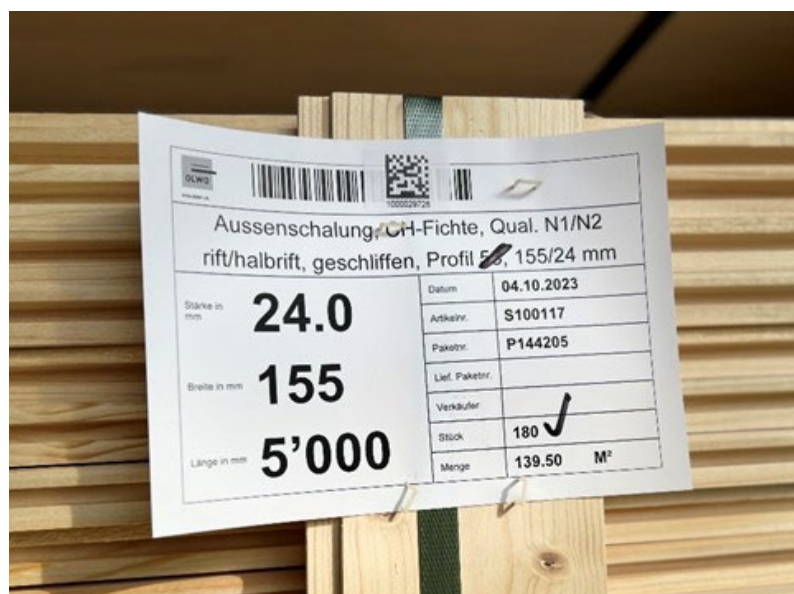
Figure 23: Etiquetage de marchandises dans une raboterie. Les détails peuvent être consultés au moyen d'un code QR. (source: deligno ag)
