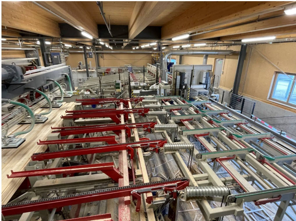
Abbildung 50: Mechanisierte Bandsägenlinie mit Vakuum-Abstapelung im Vordergrund, Vereinzelung und Zuführung zur Trennbandsäge und Ausförderung, Sortierstation und Paketierung im Hintergrund. (Quelle: OLWO AG)
