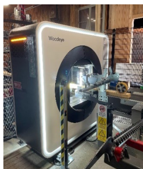
Abbildung 67: Scanner WoodEye (Quelle: OLWO AG)
