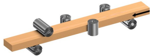
Abbildung 53: Anordnung 2 mit 6 Spindeln, unten-rechts-links-rechts-oben-unten (Quelle: Weinig)
