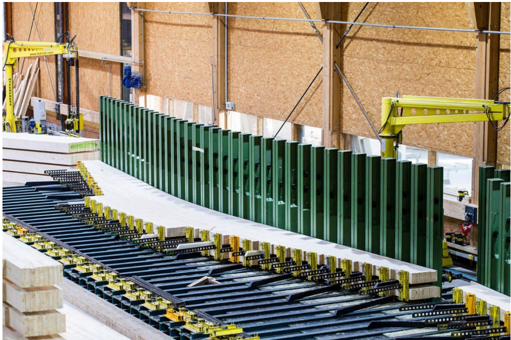
Abbildung 93: Gekrümmte, satteldachförmige Bauteile im Leimbett (Quelle: Roth Burgdorf AG)
