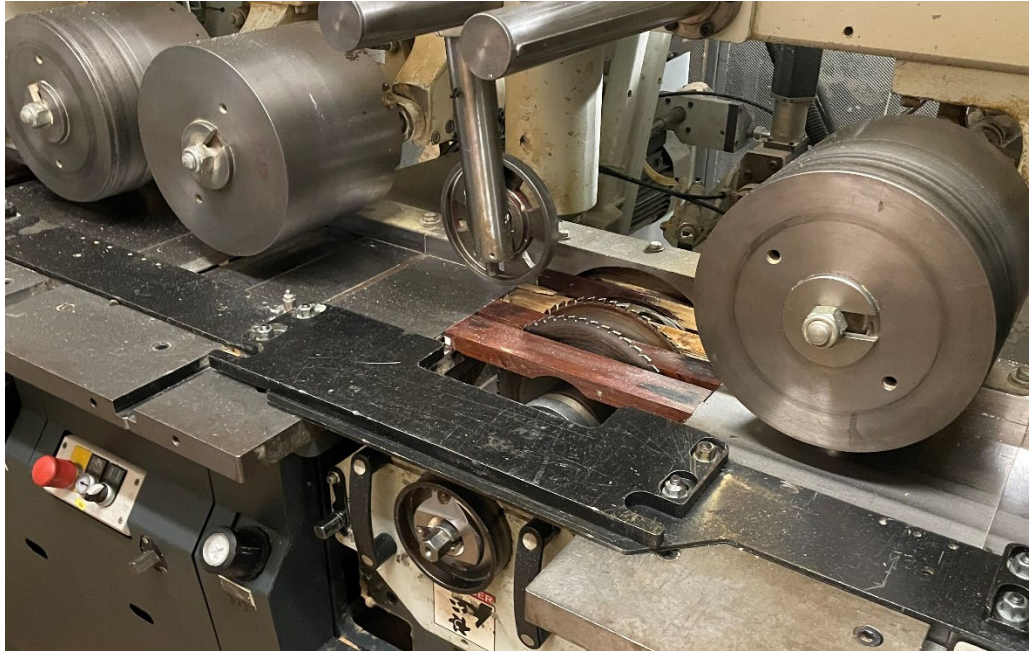
Figure 61: Dédoublage sur une raboteuse (source: OLWO AG)
