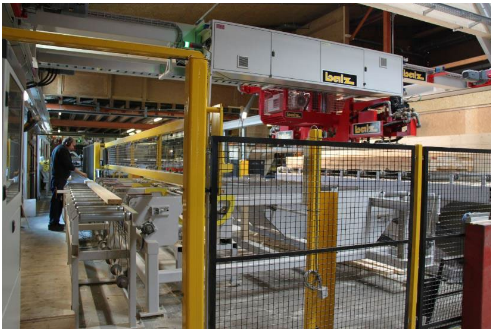
Abbildung 83: Markier-/Kappstation (Quelle: Roth Burgdorf AG)
