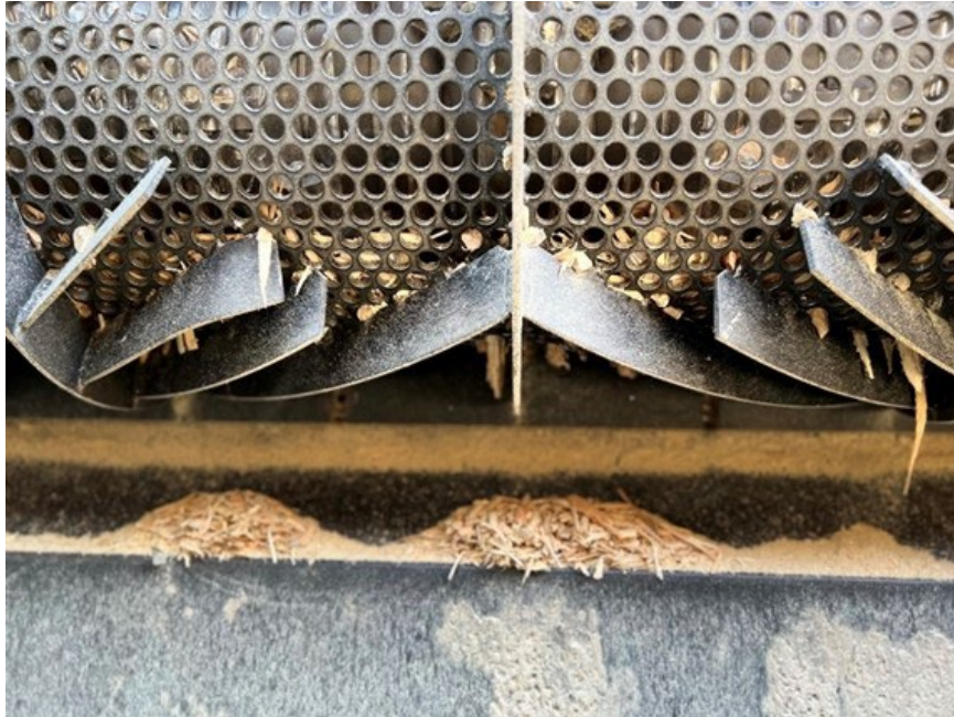
Abbildung 116: Trommelhacker im Einsatz. (Quelle: Mivelaz SA)
