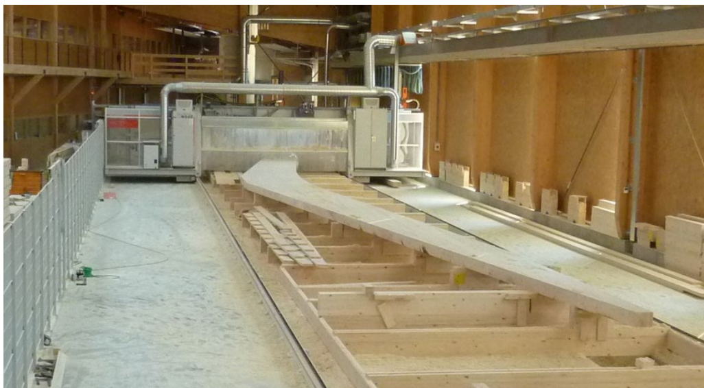
Abbildung 102: Abbund eines gekrümmten, satteldachförmigen Brettschichtholzträgers. (Quelle: Roth Burgdorf AG)
