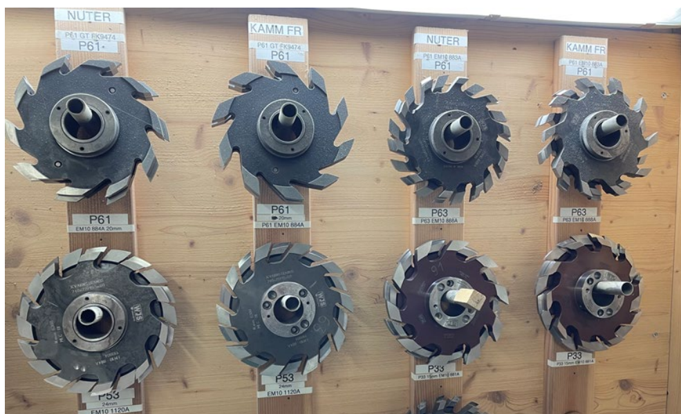
Abbildung 62: Profilköpfe (Festgarnituren) für eine Hobelmaschine mit 140 m/min Vorschub (Quelle: OLWO AG)
