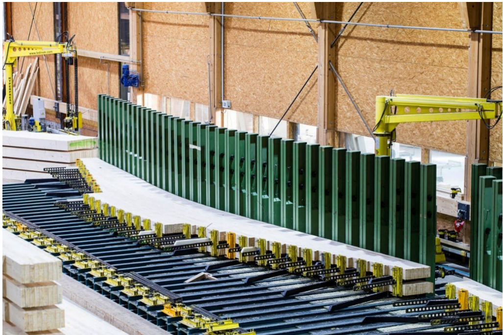
Figure 93: Élément de construction cintré pour un toit à deux pans, dans la presse. (source: Roth Burgdorf AG)
