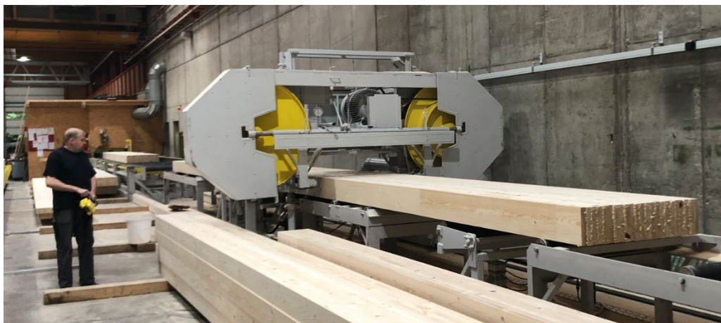
Abbildung 104: Auftrennen eines BSH Trägers mit Bandsäge. (Quelle: Roth Burgdorf AG)
