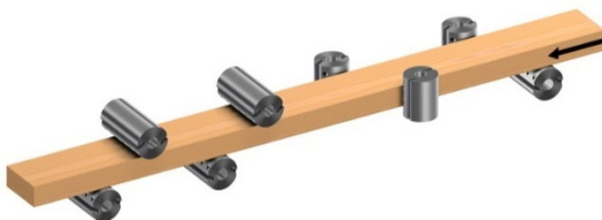
Figure 56: Disposition 5 avec 8 broches: en bas – à droite – à gauche – à droite – en haut – en bas – en haut – en bas (source: Weinig)
