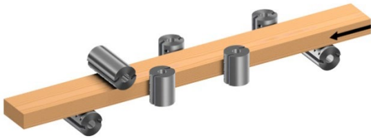
Abbildung 54: Anordnung 3 mit 7 Spindeln, unten-rechts-links-rechts-links-oben-unten (Quelle: Weinig)
