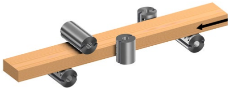
Abbildung 52: Anordnung 1 mit 5 Spindeln, unten-rechts-links-oben-unten (Quelle: Weinig)
