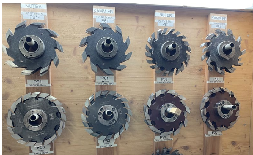
Figure 62: Outils de profilage (garnitures fixes) pour une raboteuse avec une vitesse d'avancement de 140 m/min (source: OLWO AG)
