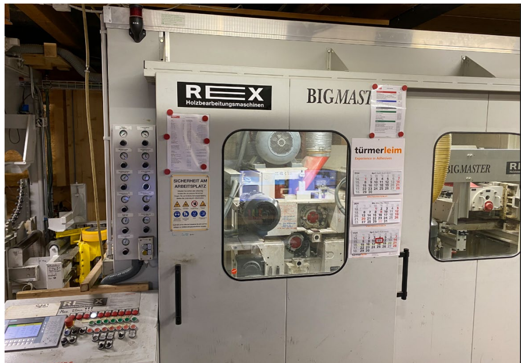
Abbildung 90: Lamellenhobelmaschine (Quelle: Roth Burgdorf AG)
