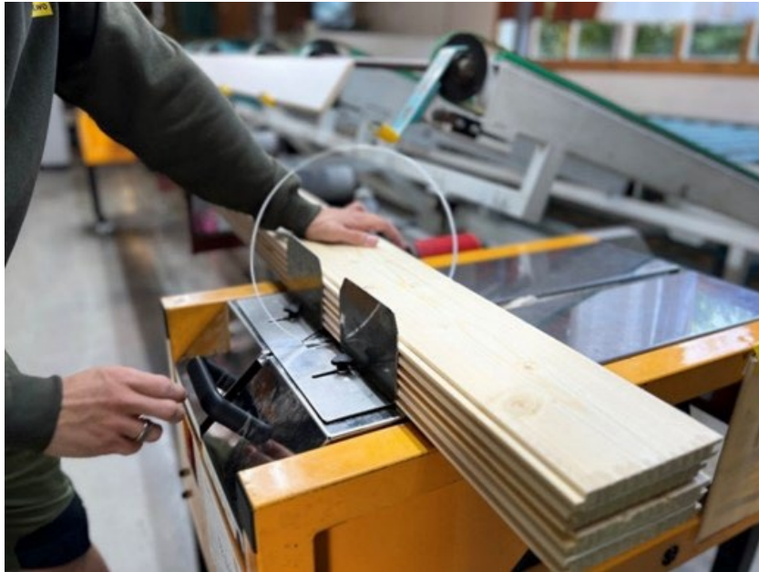
Abbildung 24: Umreifungsmaschine im Einsatz. (Quelle: OLWO AG)
