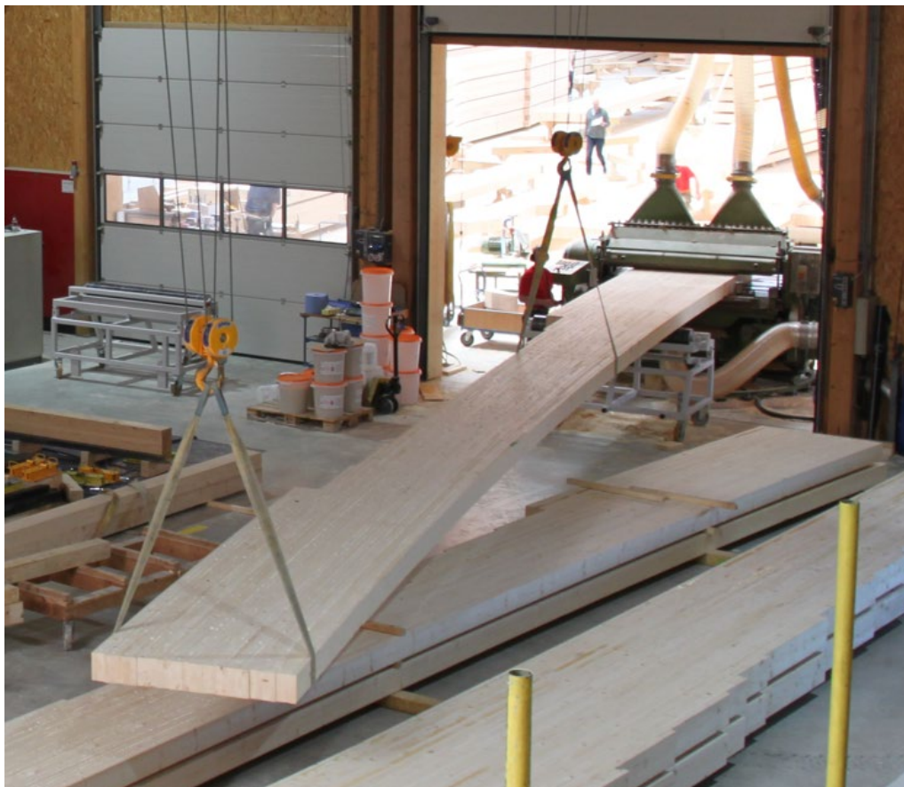
Figure 100: Rabotage d'un élément de construction cintré dans une tireuse d'épaisseur placée sur un socle rotatif. (source: Roth Burgdorf AG)
