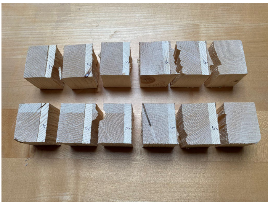
Abbildung 95: Scherprobe nach Prüfung (Quelle: Roth Burgdorf AG)
