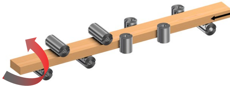
Abbildung 58: Anordnung 7 mit 9 Spindeln mit Universalwelle (Quelle: Weinig)
