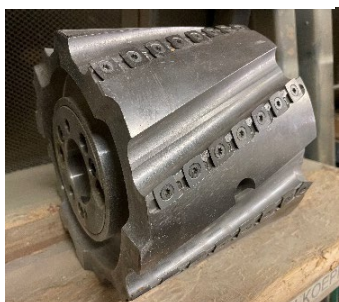
Figure 60: Tête de rabotage avec couteaux en spirale. Peu bruyant et à haute efficacité énergétique. (source: OLWO AG)
