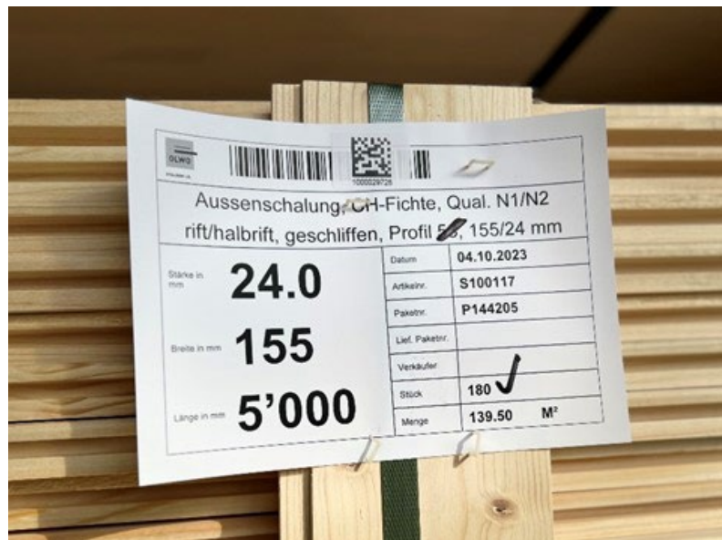
Abbildung 23: Kennzeichnung einer Ware im Hobelwerk, Details können via QR-Code sichtbar gemacht werden. (Quelle: deligno ag)
