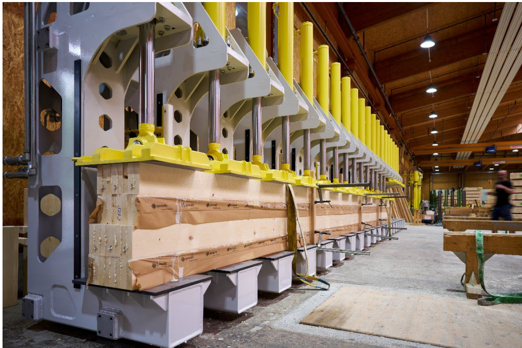
Abbildung 105: Verpressen von Verbundbauteilen (Quelle: Roth Burgdorf AG)
