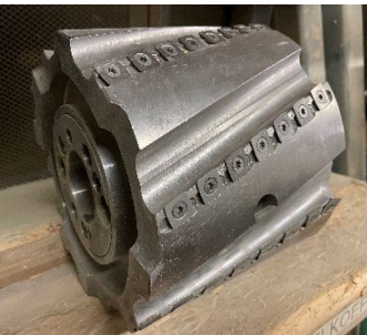
Abbildung 60: Hobelkopf mit Bestückung mit Wendemessern, lärmarm und energieeffizient. (Quelle: OLWO AG)
