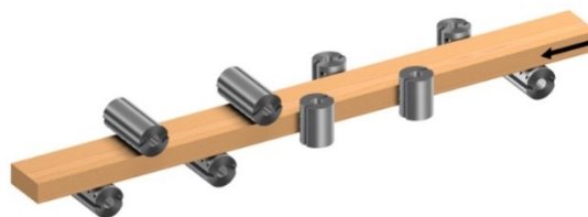
Figure 57: Disposition 6 avec 9 broches: en bas – à droite – à gauche – à droite – à gauche – en haut – en bas – en haut – en bas (source: Weinig)
