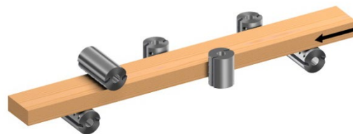
Figure 53: Disposition 2 avec 6 broches: en bas – à droite – à gauche – à droite – en haut – en bas (source: Weinig)
