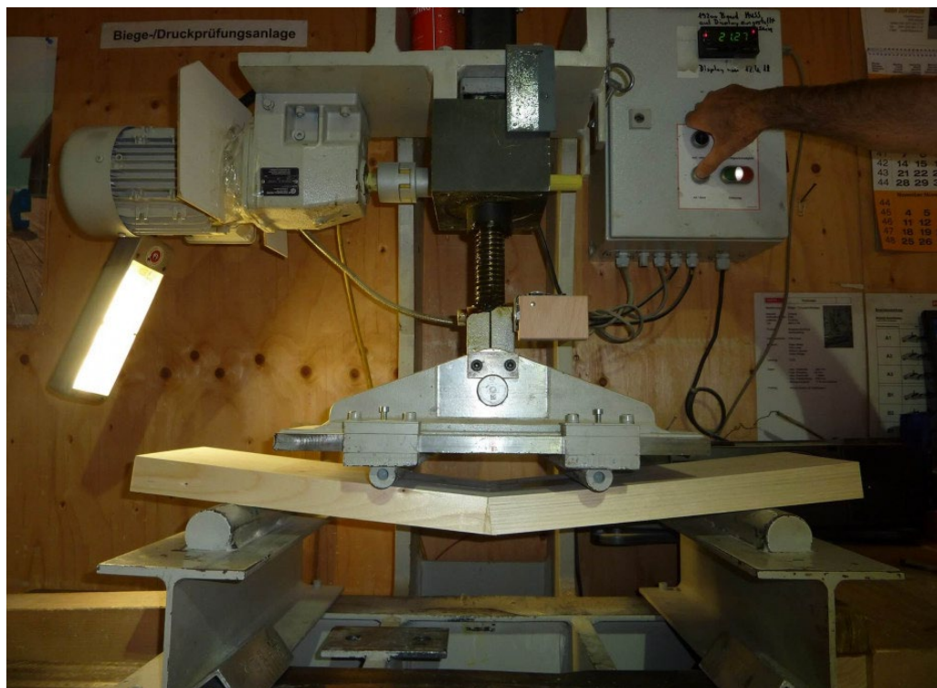
Abbildung 89: Biegeprüfung einer Keilzinkenverbindung (Quelle: Roth Burgdorf AG)
