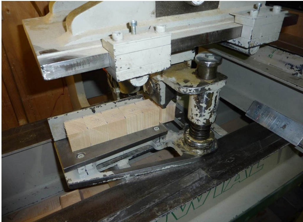
Abbildung 96: Scherprüfung (Quelle: Roth Burgdorf AG)
