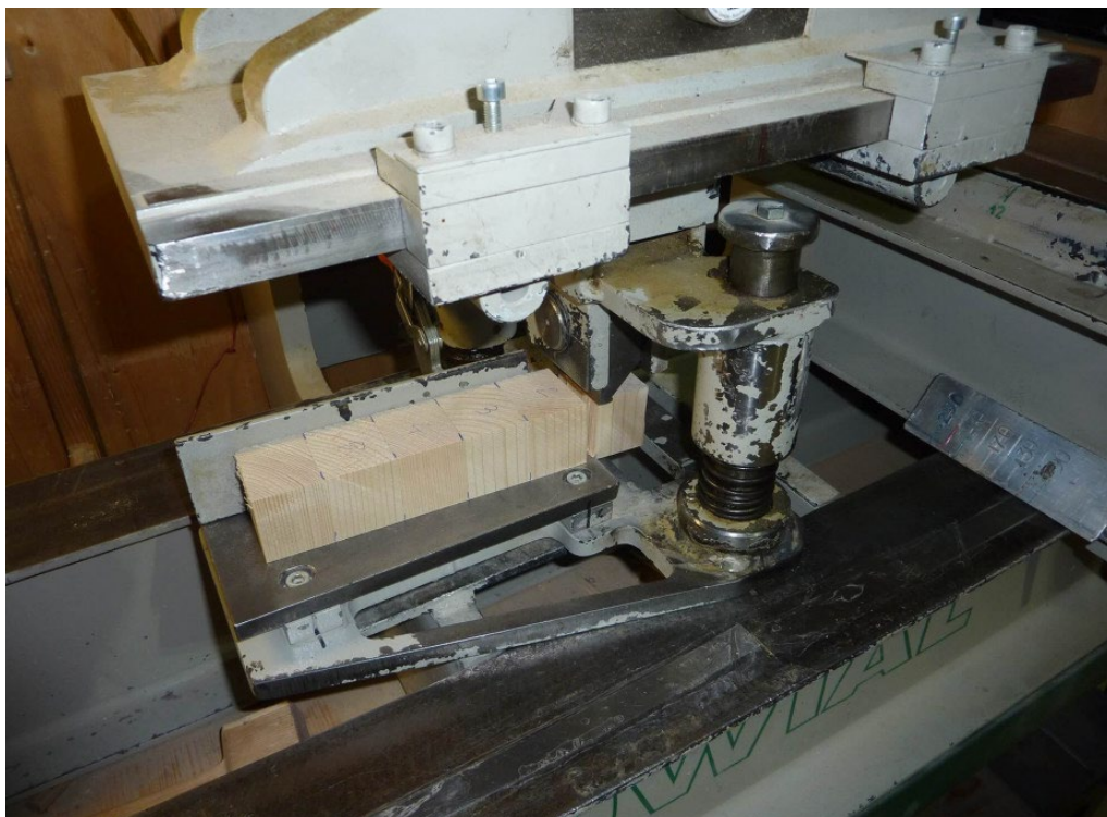
Figure 96: Dispositif pour essai de cisaillement (source: Roth Burgdorf AG)
