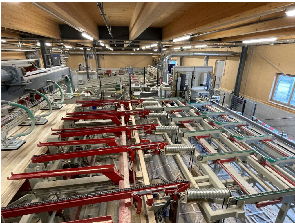
Figure 50: Ligne de scie à ruban mécanisée avec, au premier plan, le désempilage avec dispositif de levage à vide et, au second plan, la séparation, l'amenage à la scie à ruban, l'extraction et la station de triage et de paquettisation. (source: OLWO AG)
