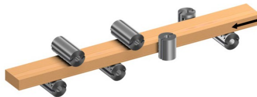
Figure 55: Disposition 4 avec 7 broches: en bas – à gauche – à droite – en haut – en bas – en haut – en bas (source: Weinig)
