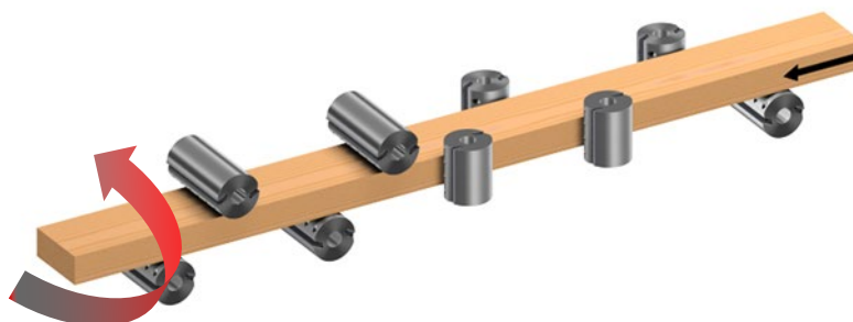
Figure 58: Disposition 7 avec 9 broches et une broche universelle (source: Weinig)
