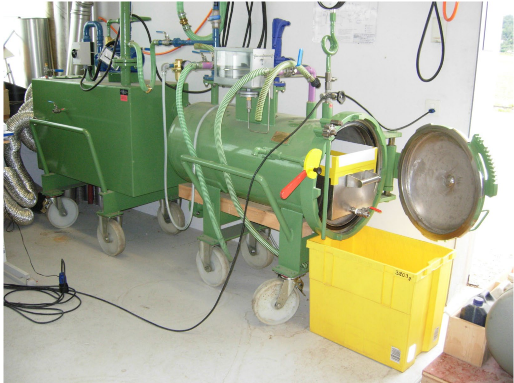
Abbildung 98: Anlage für die Delaminierungsprüfung. (Quelle: M. Lehmann, BFH-AHB)
