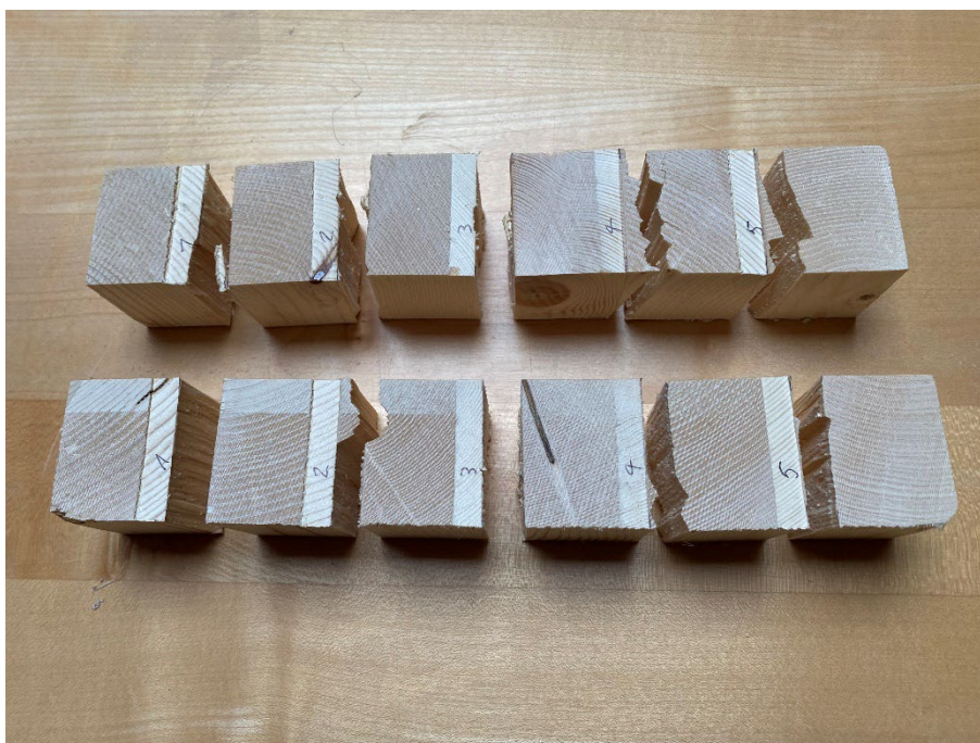
Figure 97: Eprouvettes prélevées pour l'essai de délamination (source: Roth Burgdorf AG)
