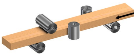
Figure 52: Disposition 1 avec 5 broches: en bas – à droite – à gauche – en haut – en bas (source: Weinig)
