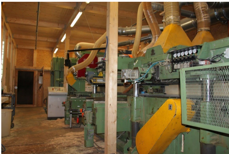
Abbildung 101: Hobeln eines Bauteiles im Vierseiter. (Quelle: Roth Burgdorf AG)
