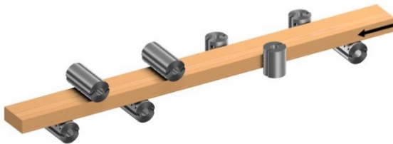
Abbildung 56: Anordnung 5 mit 8 Spindeln, unten-rechts-links-rechts-oben-unten-oben-unten (Quelle: Weinig)
