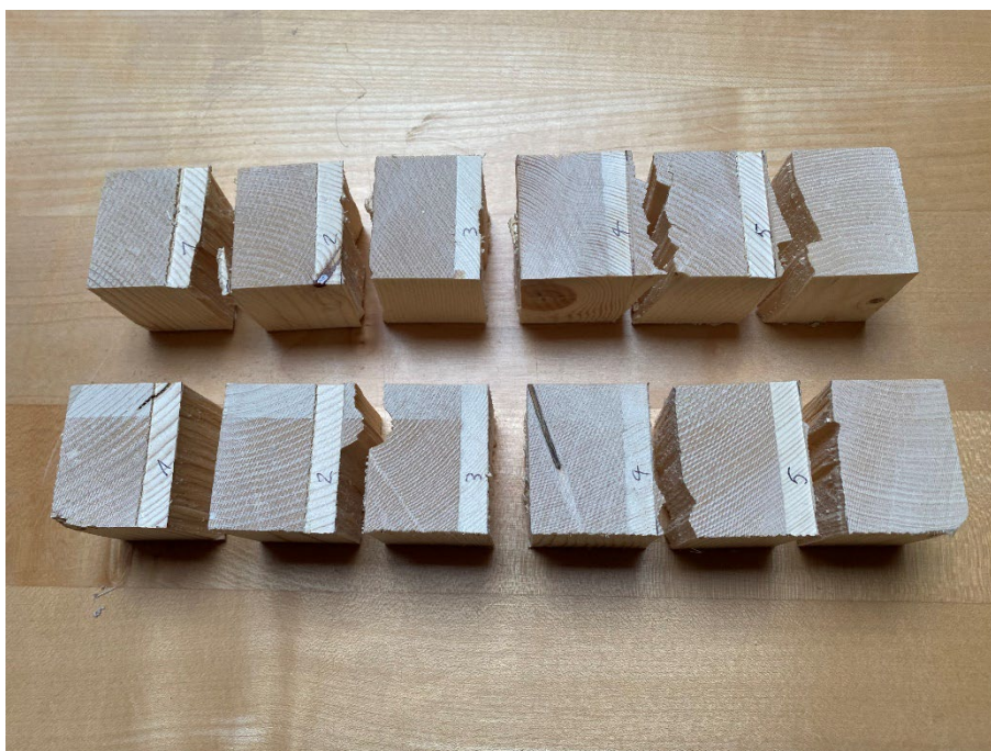
Figure 95: Éprouvettes après essai de cisaillement (source: Roth Burgdorf AG)
