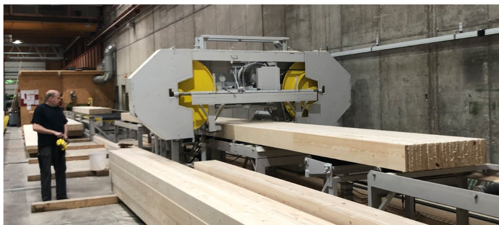
Figure 104: Dédoublage d'une poutre en BLC au moyen d'une scie à ruban. (source: Roth Burgdorf AG)
