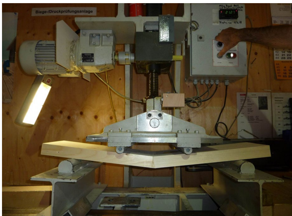
Figure 89: Essai de flexion d'un aboutage par entures multiples (source: Roth Burgdorf AG)
