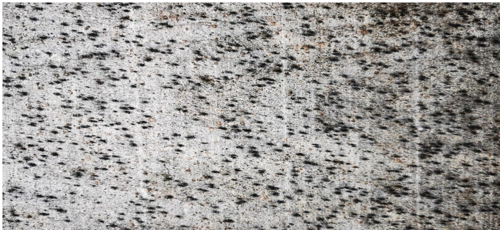
Figure 188 : Moisissures et champignons de bleuissement sur la planche latérale d'un érable sycomore après un stockage inapproprié (source : Stalder)
