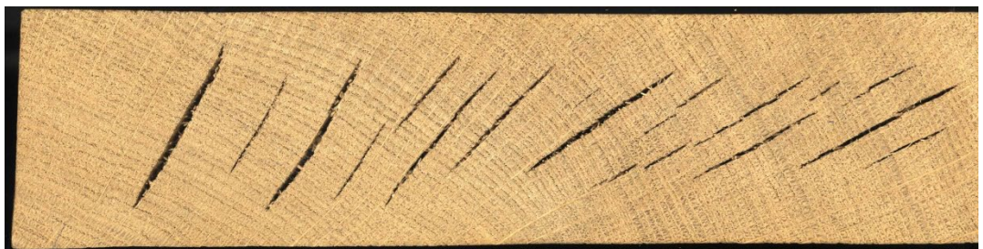
Figure 174 : Coupe transversale d'une planche de chêne mal séchée avec de fortes fentes internes (source : Lüthi)
