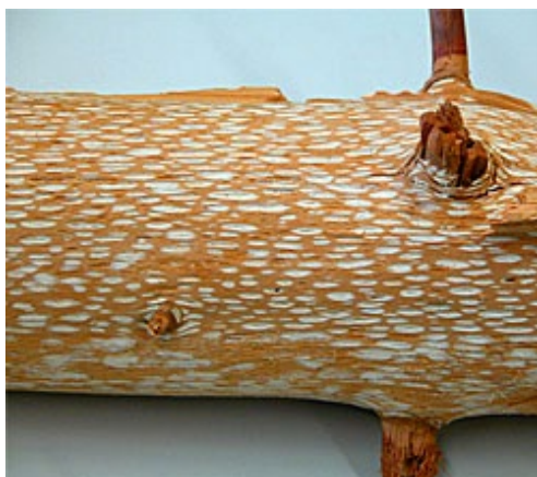
Figure 59 : Pourriture blanche sélective causée par l'amadouvier du pin (source : WSL)
