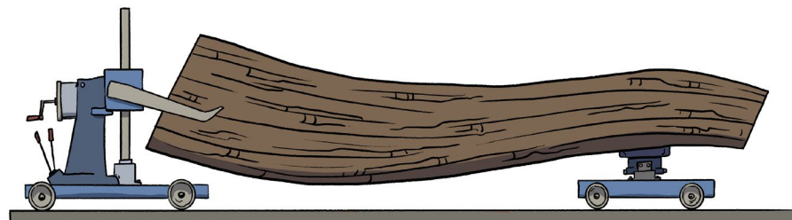
Abbildung 103: Eindrehen mit Krümmung nach unten (Quelle: HIS)
