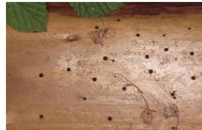
Die Käfer hinterlassen beim Schlüpfen viele kreisrunde Löcher.
