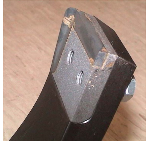
Abbildung 135: Rotor einer Lochrotorenrindungsma- schine (Quelle: Baljer & Zembrod GmbH & Co. KG)
