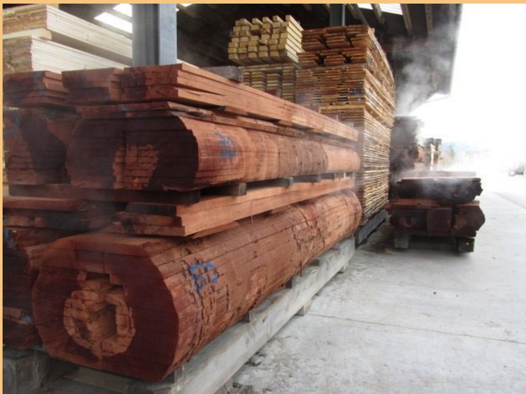
Abbildung 183: Buche frisch gedämpft (HedingerHolz AG)
