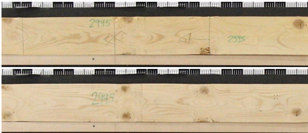
Figure 224 : Planche de bord avec gros nœuds et fibres inclinées dans le sens de l'épaisseur de la planche. En haut face 1, en bas face 2. Classement avant essai : nœud unique A = 0,37 ; nœuds groupés A = 0,61 ; classe de triage S7. La résistance à la traction de 9,4 \text{ N/mm}^2 obtenue lors de l'essai est inférieure à la valeur de 11 \text{ N/mm}^2 , caractéristique pour la classe de triage T11. (source : Fuhrmann / Sigrist)
