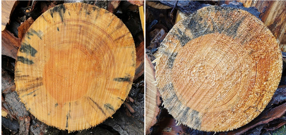
Abbildung 44: Primärbläue im Splint bei zwei Nadelholzscheiben (Quelle: Stalder)
