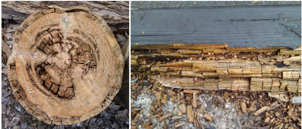
Abbildung 55: Braunfäule im Stammquerschnitt und bei einer Parkbank (Quellen: Wikimedia Foundation / Stalder)
