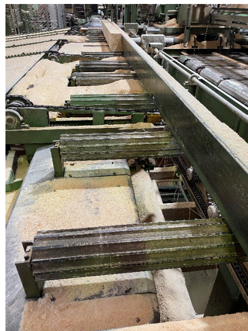
Figure 149 : Convoyeur à rouleaux d'accélération (source: Schilliger Holz AG)
