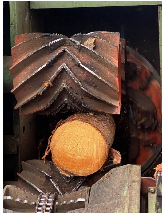
Abbildung 134: Lochrotorenrindung (Quelle: Blumer-Lehmann AG / Schilliger Holz AG)
