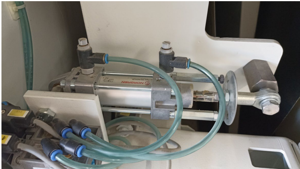
Abbildung 82: Pneumatikzylinder (Quelle: Näf Service und Maschinen AG)
