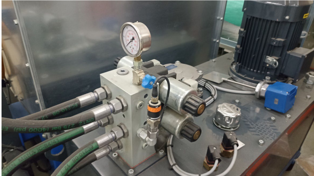
Abbildung 86: Hydraulikventil (Quelle: Näf Service und Maschinen AG)
