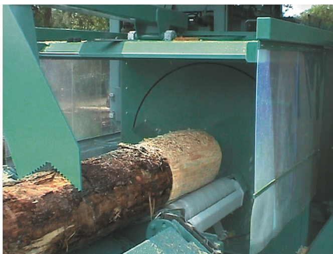
Figure 137 : Réducteur d'empattements avec arbre de fraisage périphérique (source : Baljer & Zembrod GmbH & Co. KG)
