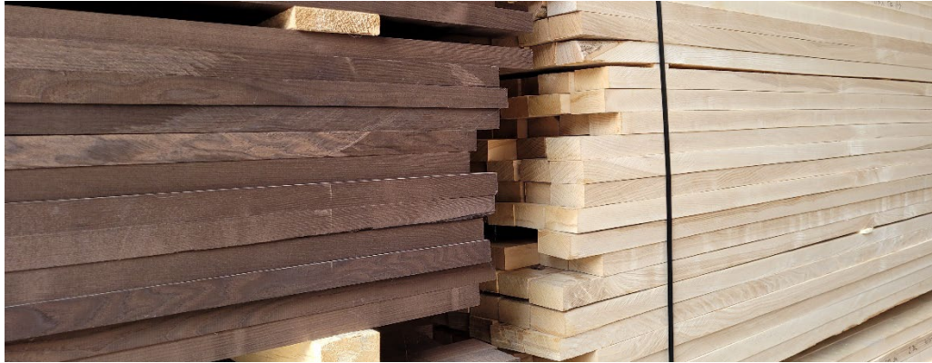
Abbildung 196: Esche thermo - nativ (Quelle: Balz Holz AG)
