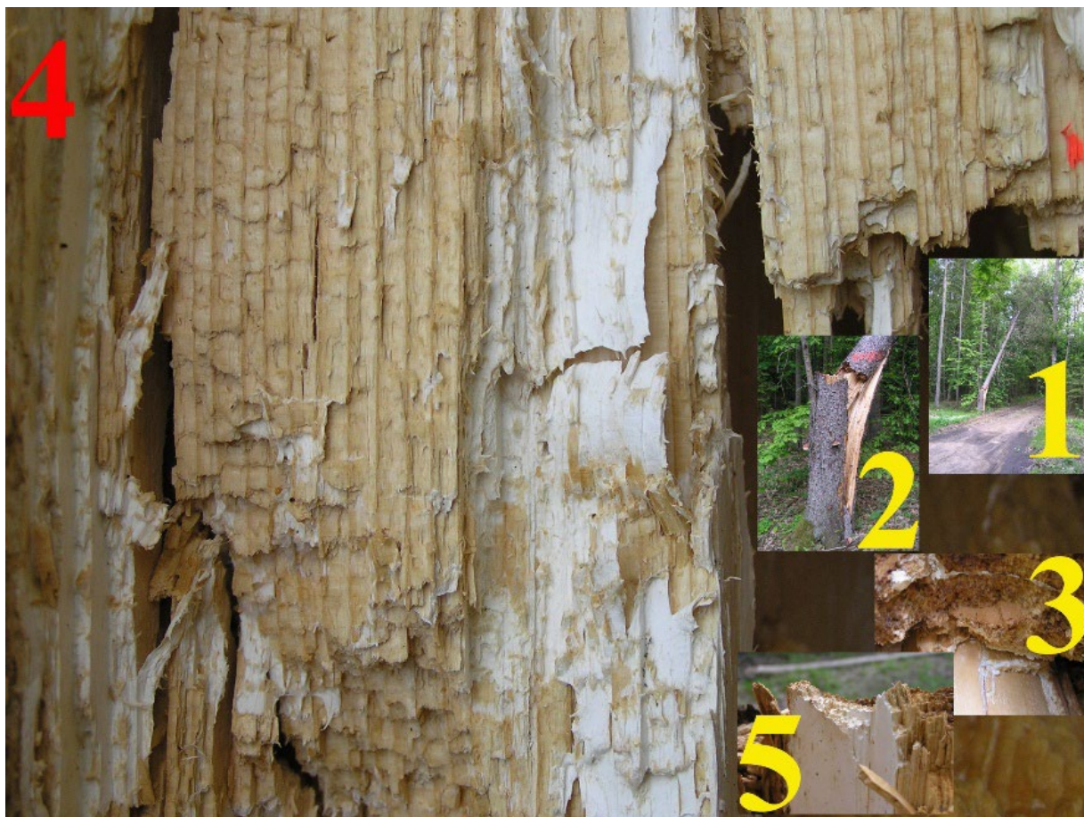
Figure 53 : « Pourriture blanche », « Pourriture blanche sélective » sur de l'épicéa (source : Wikimedia Foundation)
