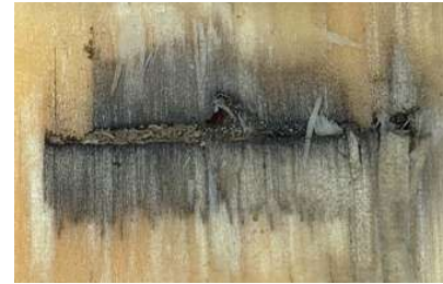
Bohrgang des Mutterkäfers mit gut sichtbarer Verfärbung durch Ambrosiapilze.
