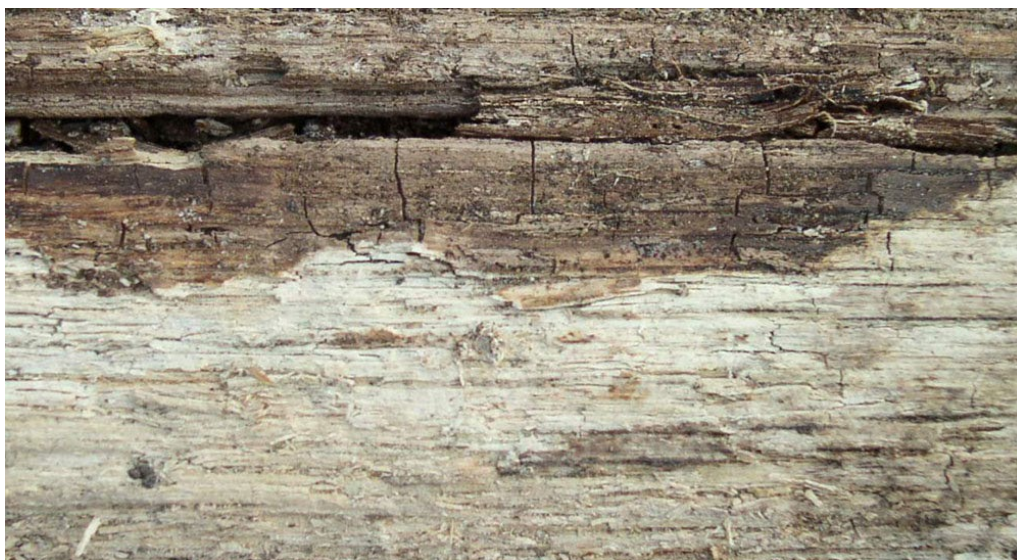
Figure 42 : Pourriture brune (en haut) et pourriture blanche (en bas) sur la même pièce de bois (source : Wikimedia Foundation)
