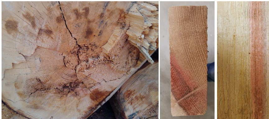
Abbildung 52: Schadbilder von Kernfäule und Rotstreifigkeit ausgehend von Wurzelschwamm oder Hallimasch an Fichtenholz (Quelle: Stalder)
