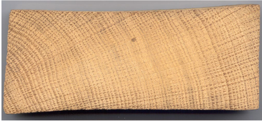
Figure 175 : Collapsus cellulaire du chêne lors de séchage sous vide (source : Lüthi)
