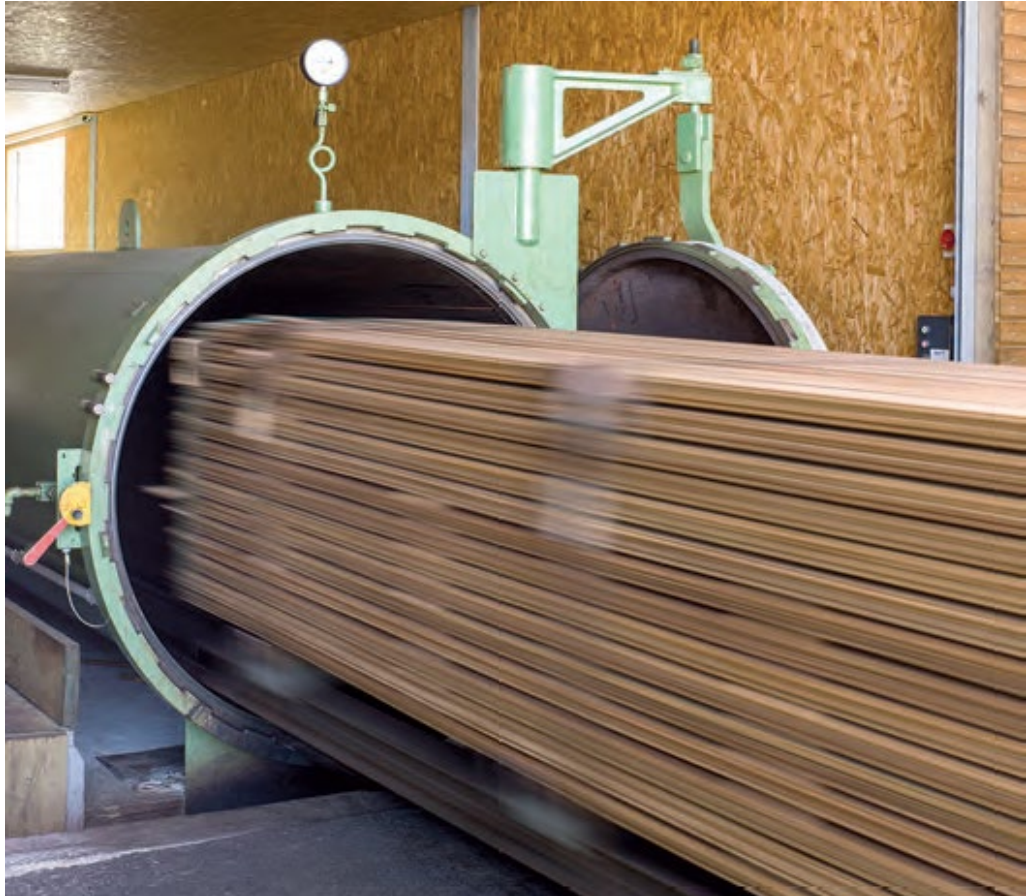
Abbildung 203: Autoklav für die Druckimprägnierung (Quelle: Imprägnierwerk AG Willisau)
