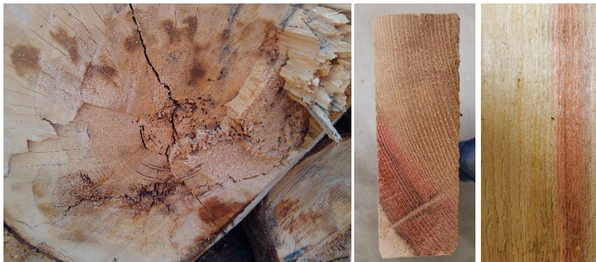
Figure 52 : Dommages causés au bois d'épicéa par la pourriture du cœur et les caries rouges dues à l'amadouvier ou à l'armillaire (source : Stalder)
