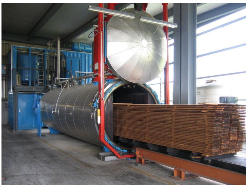
Figure 195 : Installation pour procédé de séchage par pressage vacuum (source : Balz Holz AG)
