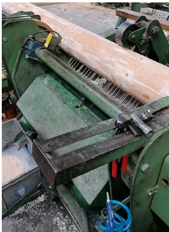
Abbildung 204: Bohrkopf für die Bohrperforation (rechts), mit Schlitzperforation vorbehandeltes, druckimprägniertes Rundholz (Quelle: Imprägnierwerk AG Willisau)
