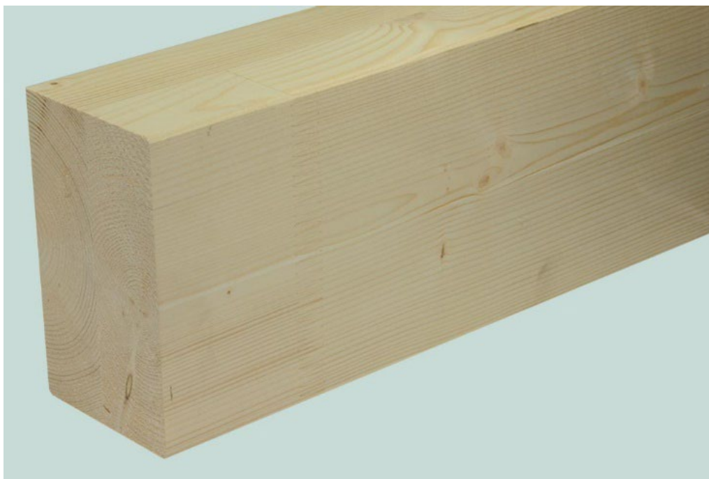
Figure 234 : Bois massif reconstitué d'épicéa en qualité normale (N), calibré et chanfreiné (source : Lignum, 2021a)
