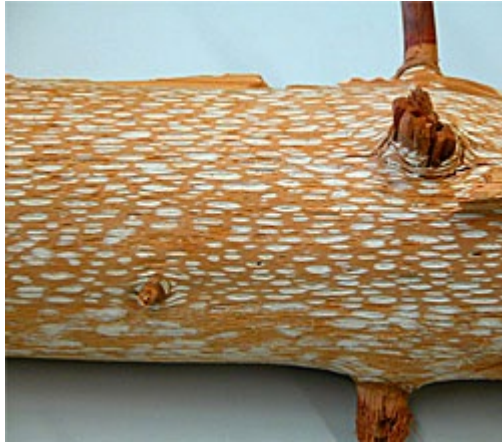
Abbildung 59: Weisslochfäule durch den Kiefern-Feuerschwamm verursacht (Quelle: WSL)
