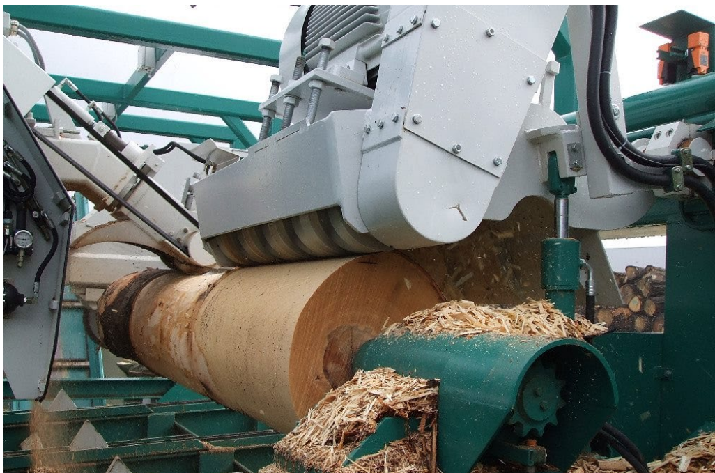
Abbildung 133: Fräskopfentrinder (Quelle: Baljer & Zembrod GmbH & Co. KG)
