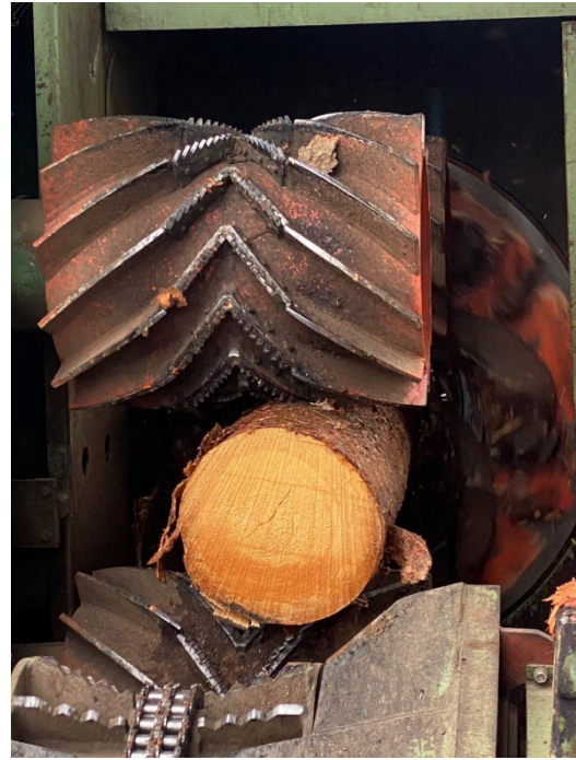
Figure 134 : Ecorceuse à rotor (source : Blumer-Lehmann AG / Schilliger Holz AG)
