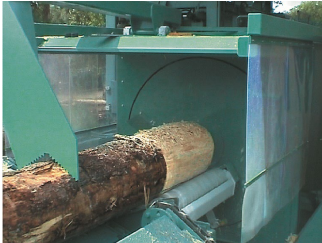
Abbildung 137: Wurzelreduzierer mit umlaufender Fräsewelle (Quelle: Baljer & Zembrod GmbH & Co. KG)
