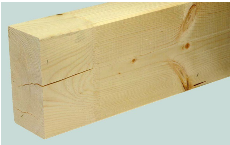
Figure 232 : Bois massif à entures multiples d'épicéa en qualité industrie (I), calibré et chanfreiné (source : Lignum, 2021a)
