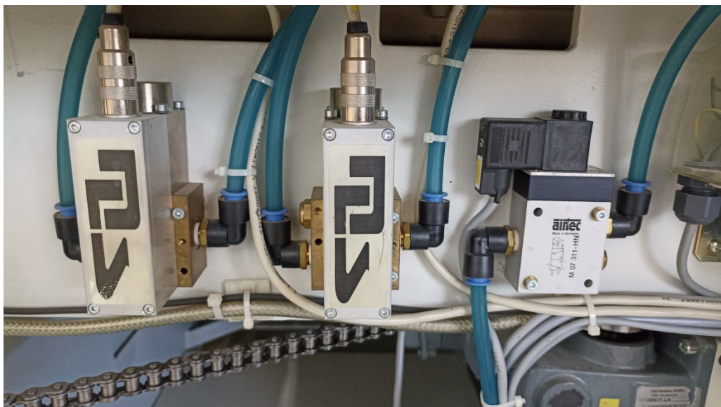
Abbildung 81: Pneumatikventile (Quelle: Näf Service und Maschinen AG)
