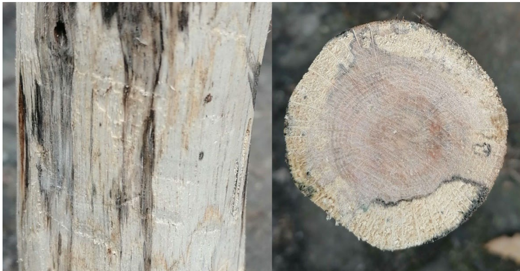
Abbildung 58: Weissfäule an einem Eichenpfosten (Quelle: Wikimedia Foundation)
