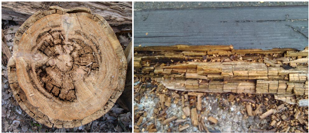
Figure 55 : Pourriture brune dans la section transversale du tronc et sur le banc public (sources : Wikimedia Foundation / Stalder)
