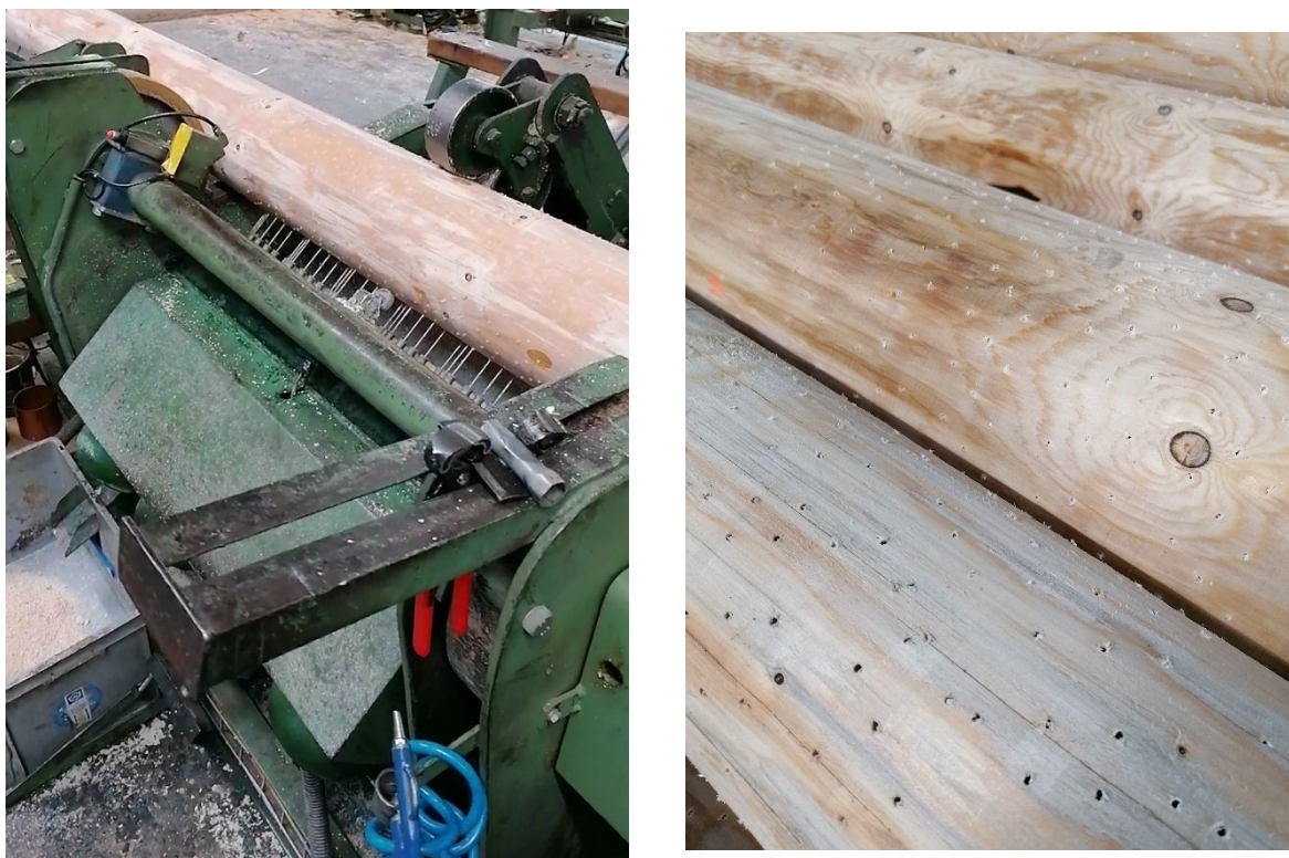
Figure 204 : Tête de perçage pour la perforation de perçage (à gauche), bois rond prétraité et imprégné sous pression avec perforation de fente (à droite) (source : Imprägnierwerk AG Willisau)
