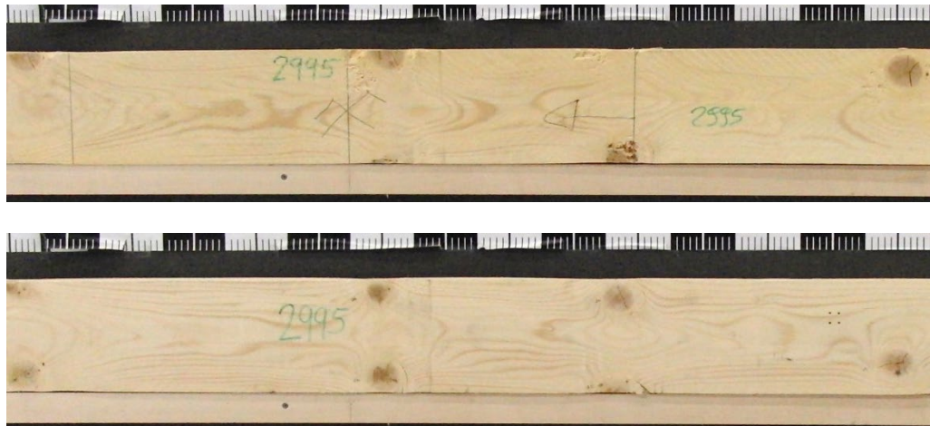
Abbildung 224: Seitenbrett grösseren Ästen und Schrägfaserigkeit in Richtung der Brettdicke Bild oben Breitseite 1, Bild unten Breitseite 2. Vorherige Sortierung: Einzelast A = 0,37; Astansammlung A = 0,61; Sortierklasse S7 Die im Versuch erreichte Zugfestigkeit von 9,4 N/mm 2 ist tiefer als der charakteristische Wert der Zugfestigkeit von 11 N/mm 2 für die zugeordnete Festigkeitsklasse T11. (Quelle: Fuhrmann / Sigrüst)
