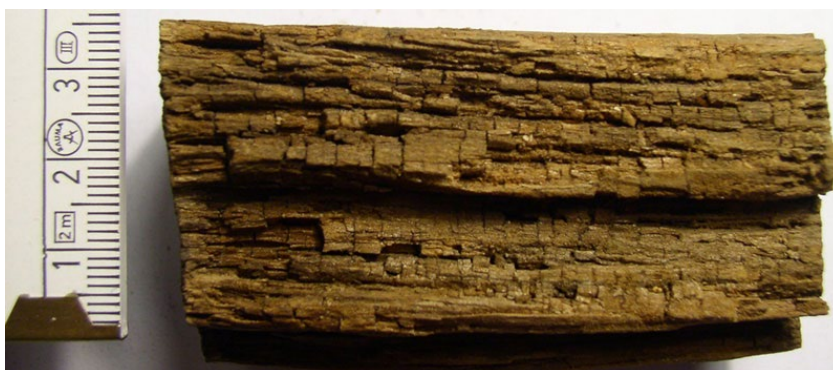
Figure 61 : Pièce de bois dégradée par la pourriture molle, avec une structure cubique fine typique (source : Wikimedia Foundation)
