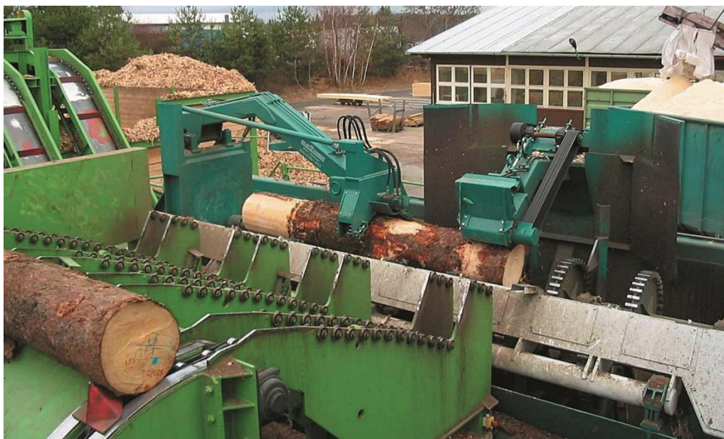
Figure 138 : Machine combinée de réduction et d'écorçage (source : Baljer & Zembrod GmbH & Co. KG)
