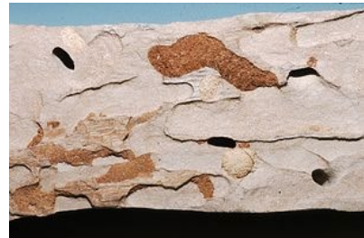
Frassgänge, teilweise mit Frassmehl gefüllt. Die ovalen Löcher sind der Beginn der Hakengänge für die Verpuppung.
