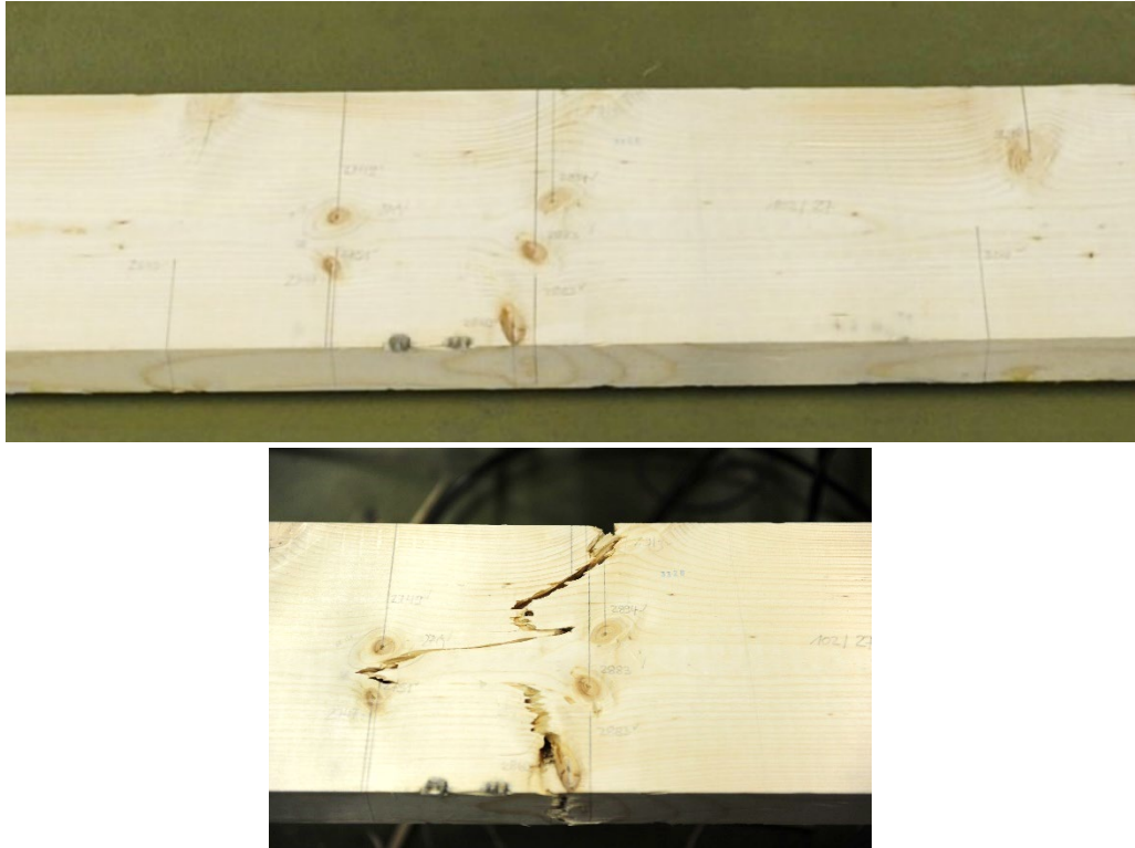
Figure 223 : Planche de cœur avec nœuds groupées sur les arrêtes/chants. En haut face 1, au milieu face 2, en bas, face 1 après rupture en traction. Classement avant essai : nœud unique A = 0,25 ; nœuds groupés A = 0,502 ; classe de triage S7. La résistance à la traction de 10,4 \text{ N/mm}^2 obtenue lors de l'essai est inférieure à la valeur de 11 \text{ N/mm}^2 , caractéristique pour la classe de triage T11. (source : Fuhrmann / Deublein)
