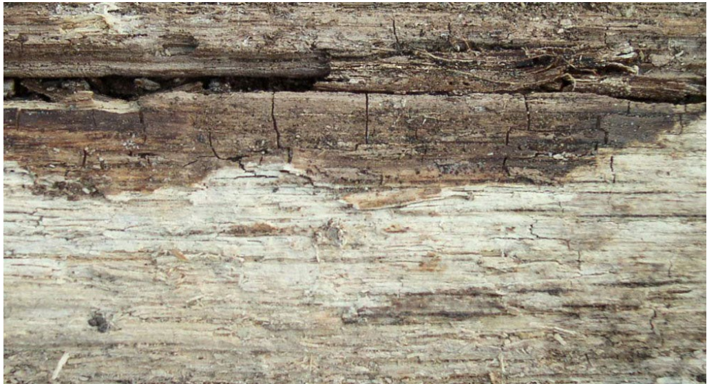
Abbildung 42: Braunfäule (oben) und Weissfäule (unten) am selben Holzstück (Quelle: Wikimedia Foundation)
