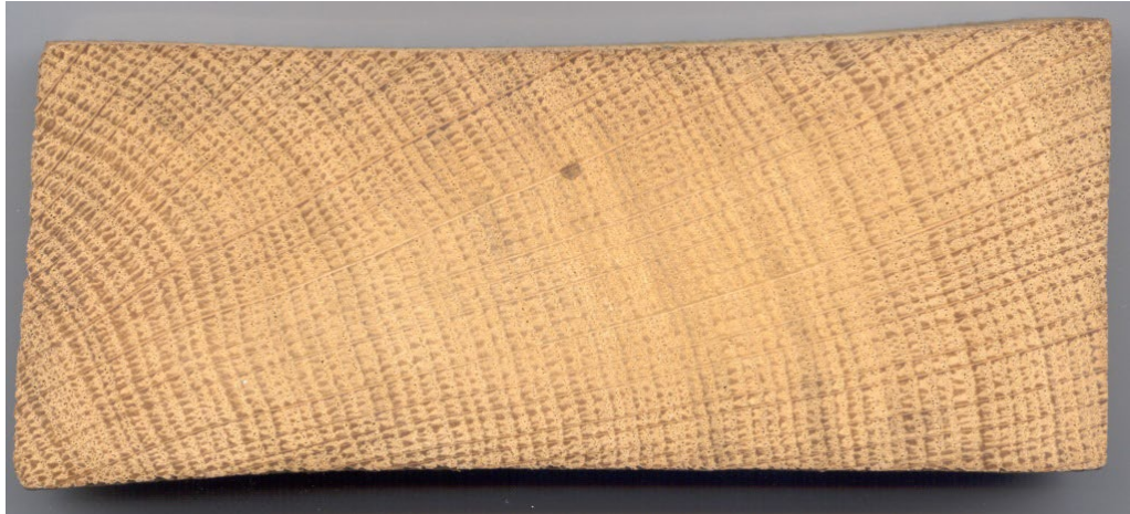
Abbildung 175: Zellkollaps Eiche durch Vakuumtrocknung (Quelle: C. Lüthi)
