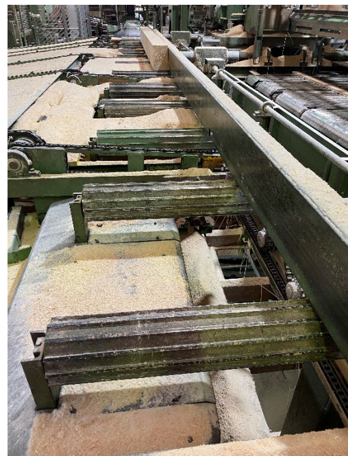
Abbildung 149: Beschleunigungsrollengang (Quelle: Schilliger Holz AG)
