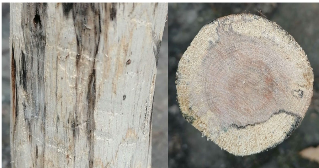
Figure 58 : Pourriture blanche sur un poteau en chêne (source : Wikimedia Foundation)
