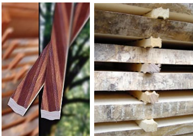
Figure 172 : Lattes d'empilage réduisant la surface d'appui (source : Lüthi)
