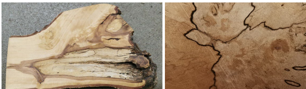
Figure 60 : Bois de feuillus atteint de pourriture blanche. Bien visible : la délimitation entre le bois sain et le bois infecté (source : Stalder)
