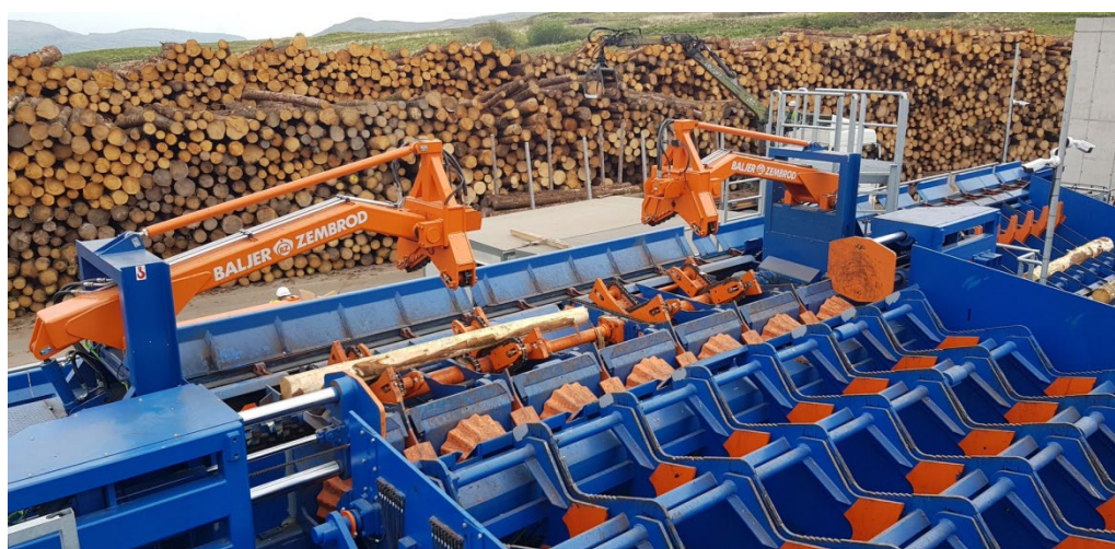
Figure 136 : Différents réducteurs d'empattements (source : Baljer & Zembrod GmbH & Co. KG)
