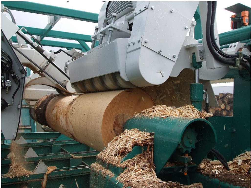
Figure 133 : Ecorceuse à tête de fraisage (source : Baljer & Zembrod GmbH & Co. KG)
