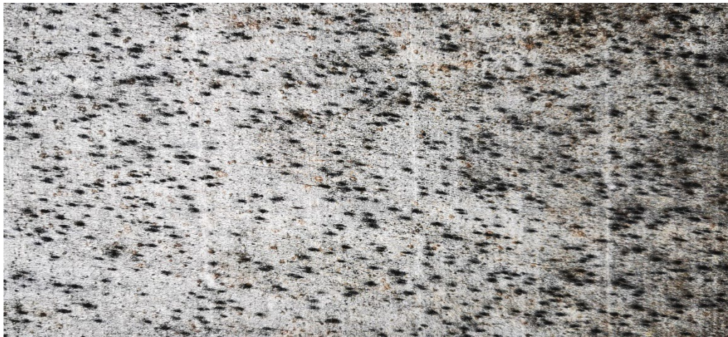
Abbildung 188: Schimmel- und Bläuepilzbefall an Seitenbrett von Bergahorn nach unsachgemässer Lagerung (Quelle: Stalder)
