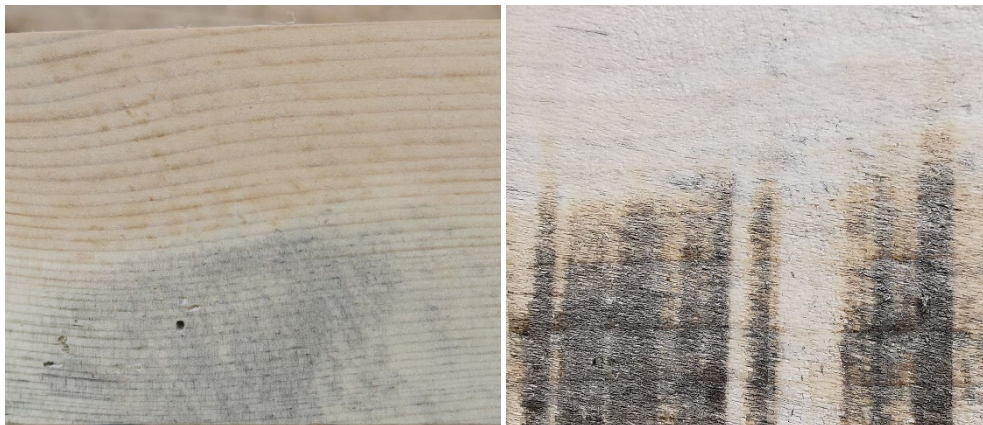
Abbildung 45: Sekundärbläue links an einem Nadelholz, rechts an Laubholz (Quelle: Stalder)
