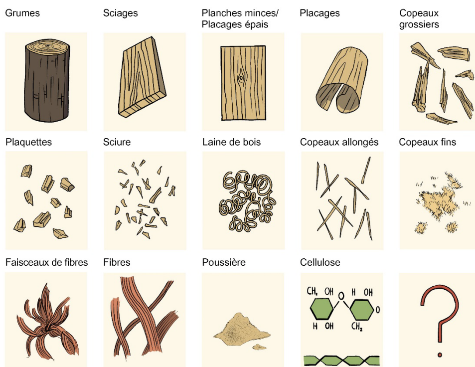
Figure 239 : Eléments structuraux des dérivés du bois (source : IBS selon Dunky)
