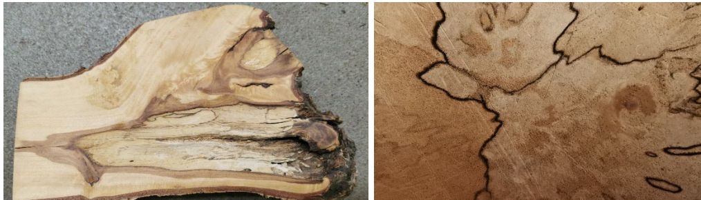
Abbildung 60: Laubholz mit Weissfäulebefall. Gut sichtbar: die Abgrenzung zwischen gesundem und befallenem Holz (Quelle: Stalder)
