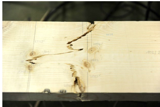
Abbildung 223: Markbrett mit Kanten-/Schmalseitenästen in Astansammlung. Bild oben Breitseite 1, Bild Mitte Breitseite 2, Bild unten Breitseite 1 nach dem Zugbruch. Vorherige Sortierung: Einzelast A = 0,25; Astansammlung A = 0,502; Sortierklasse S7. Die im Versuch erreichte Zugfestigkeit von 10,4 N/mm 2 ist tiefer als der charakteristische Wert der Zugfestigkeit von 11 N/mm 2 für die zugeordnete Festigkeitsklasse T11. (Quelle: Fuhrmann / Deublein)
