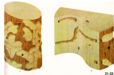
Larvengänge unter der Rinde und Bohrgänge im Holz.
