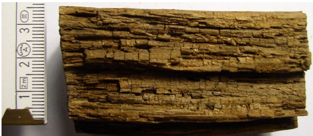
Abbildung 61: Von Moderfäule abgebautes Holzstück mit dem typischen feinstrukturierten Würfelbruch (Quelle: Wikimedia Foundation)
