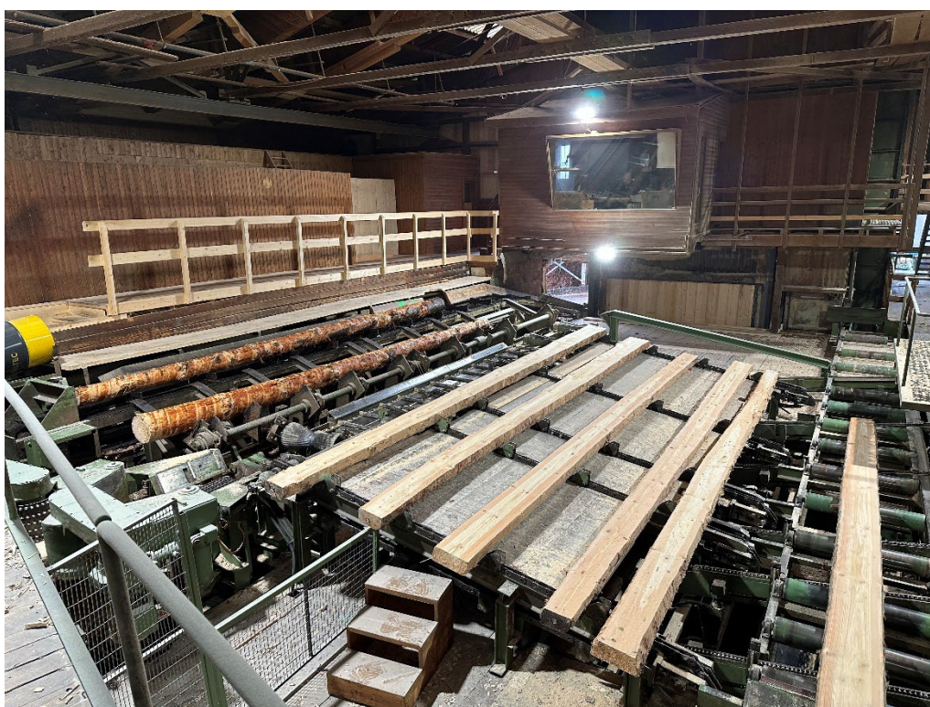
Figure 44 : Centre de scies circulaires (source : P. Schilliger Holz AG)
