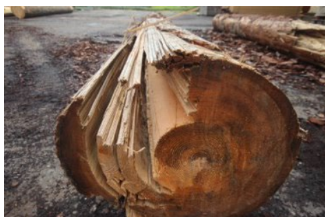
Figure 129 : Nodosité, roulure, cœur humide (source : Schilliger Holz AG, Scierie Codourey SA)
