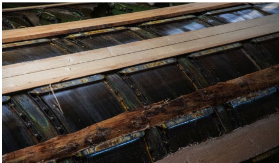
Figure 188 : Convoyeur en continu (source : Blumer Lehmann AG)
