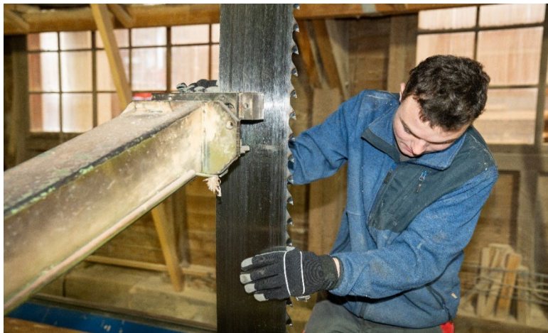
Abbildung 172: Auflegen eines Sägeblattes (Quelle: Scierie SYB Sàrl)
