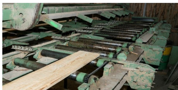
Figure 190 : Convoyeur à éléments / convoyeur à rouleaux (sources : Lang Sägewerk AG / Ruedersäge AG)
