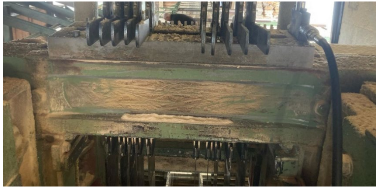
Abbildung 154: Sägeblattangeln und Keile auf oberem Rahmenbalken (Quelle: Yerly Bois SA)
