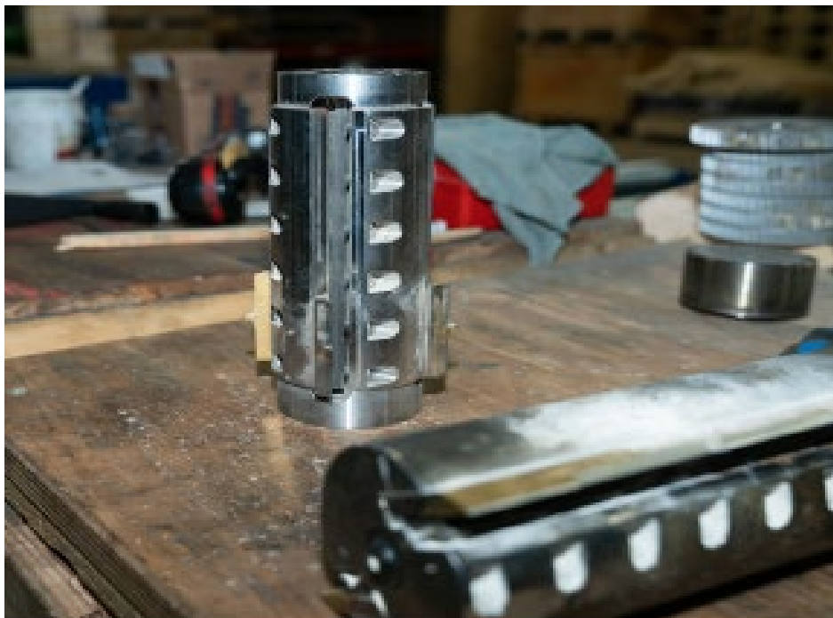
Figure 45 : Tête de rabotage (source : Ruedersäge AG)
