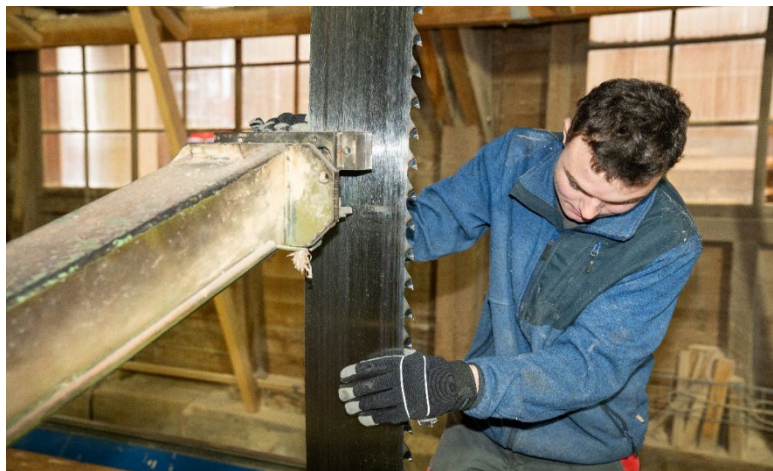
Figure 172 : Mise en place d'une lame de scie (source : Scierie SYB Sàrl)
