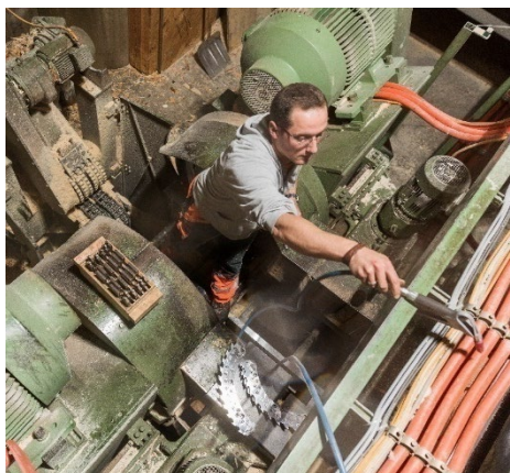
Figure 148 : Changement d'outil disque de canter (source : Blumer Lehmann AG)
