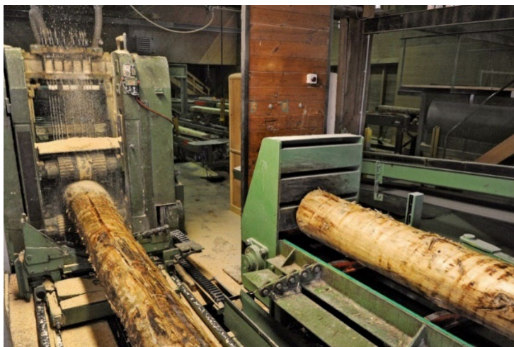
Figure 149 : Scie multiple (source : Blumer Lehmann AG)
