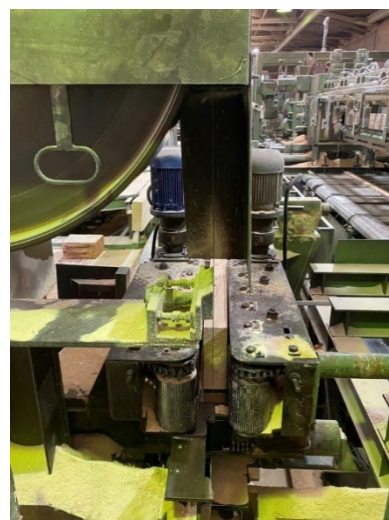
Figure 99 : Ruban dédoubleur (source : Schilliger Holz AG)
