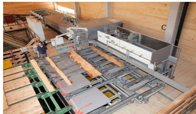
Abbildung 89: Schema Doppelbesäumkreissäge KME2 / Kombinierte Nachschnittenanlage (Quelle: Paul Maschinen Fabrik GmbH & Co. KG)
