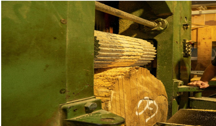
Abbildung 157: Vorschubwalzen eines Vollgatters (Quelle: Lang Sägewerk AG)
