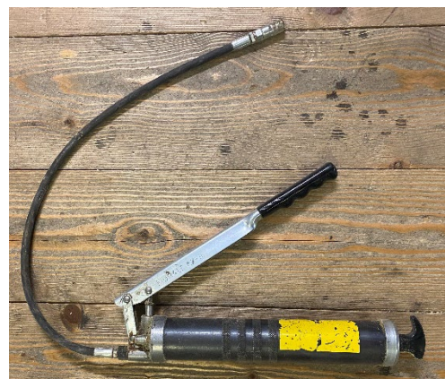
Figure 47 : pompes à graisses (source : OLWO AG)
