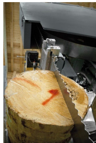
Abbildung 171: Magnetführung (Quelle: EWD)
