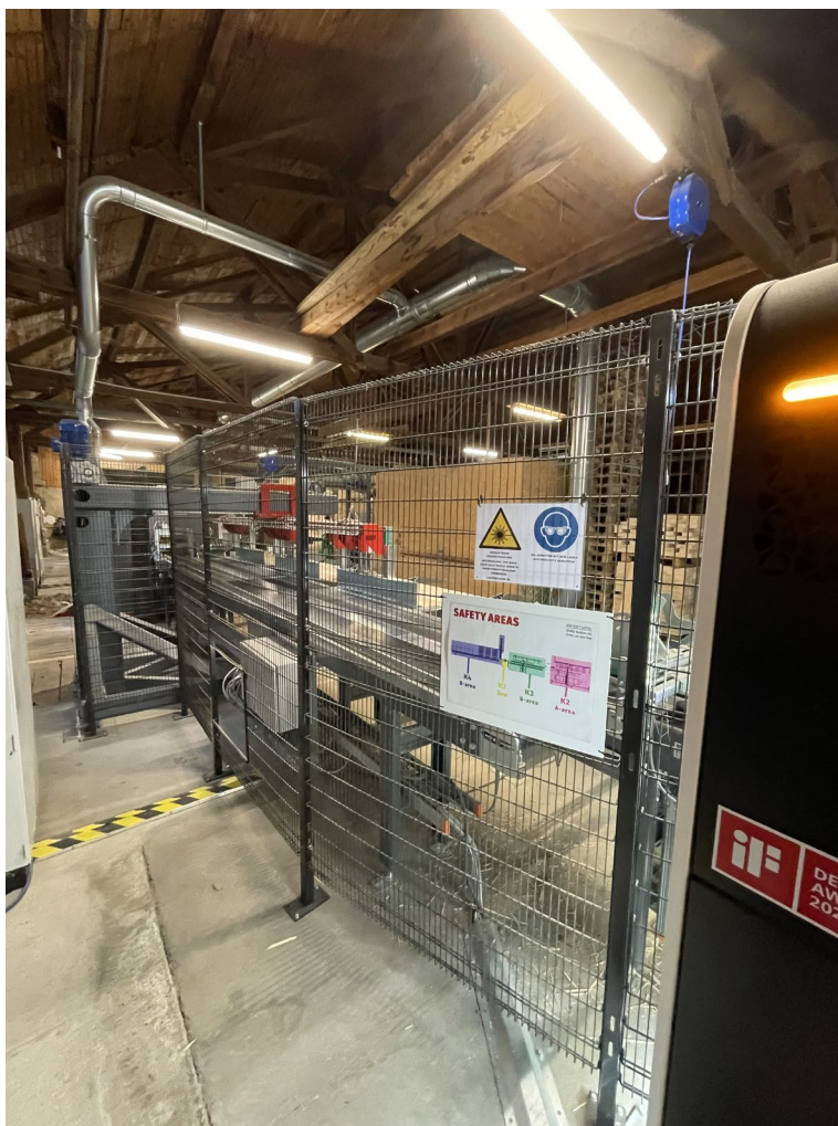
Figure 193 : Grillage de sécurité autour de l'installation (source :OLWO AG)
