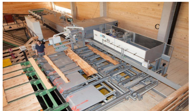
Figure 89 : Schéma de la scie circulaire double KME2 / Installation de reprise combinée (source : Paul Maschinen Fabrik GmbH & Co. KG)
