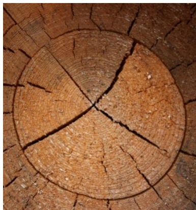
Figure 137 : Fentes de dessèchement et roulure, inclusion d'écorce (source : Schilliger Holz AG)
