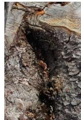
Figure 137 : Fentes de dessèchement et roulure, inclusion d'écorce (source : Schilliger Holz AG)
