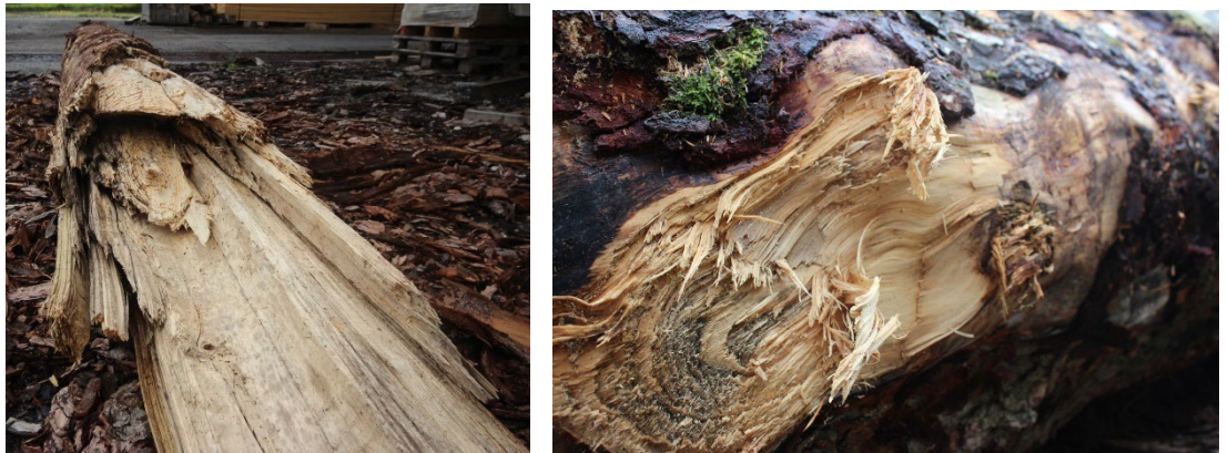
Figure 138 : Dégâts dus à la foudre, contre-fil (source : Schilliger Holz AG)
