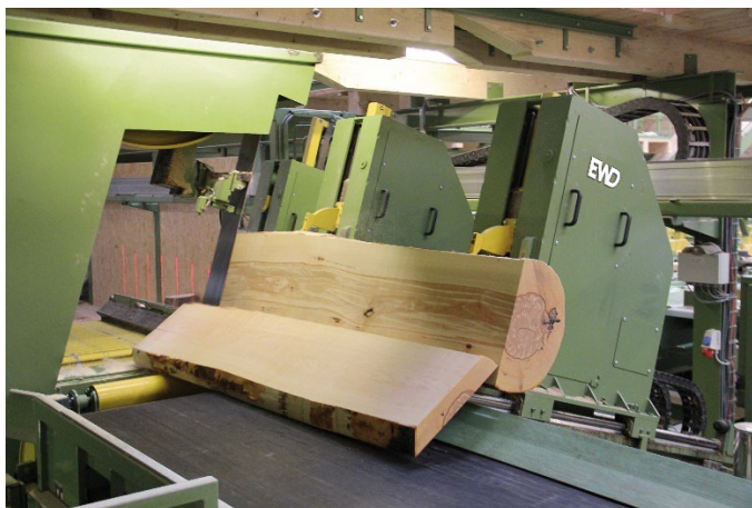
Figure 164 : Scie à ruban inclinée (source : EWD)
