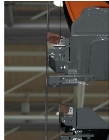
Figure 170 : Guide-lame à pression (source : EWD)
