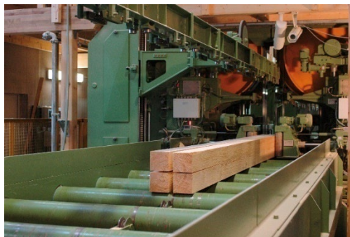
Figure 166 : Scie de réduction à ruban (source : EWD)
