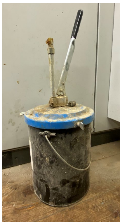
Figure 46 : Unité de lubrification centralisée (source : Baljer & Zembrod)
