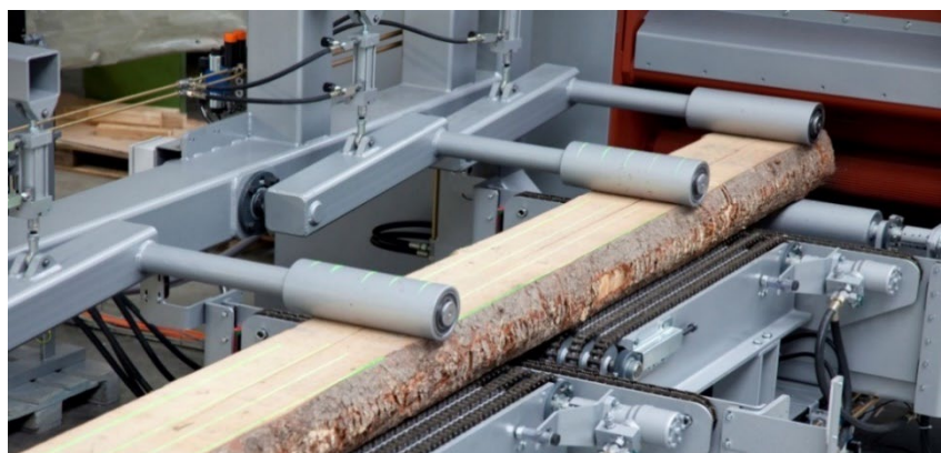
Figure 97 : Alimentation semi-automatique (source : Paul Maschinen Fabrik GmbH & Co. KG)
