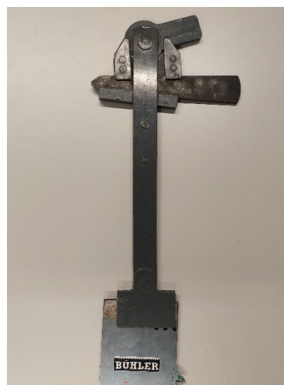
Figure 153: Chape avec lame et clavette (Source: S. Codourey)
