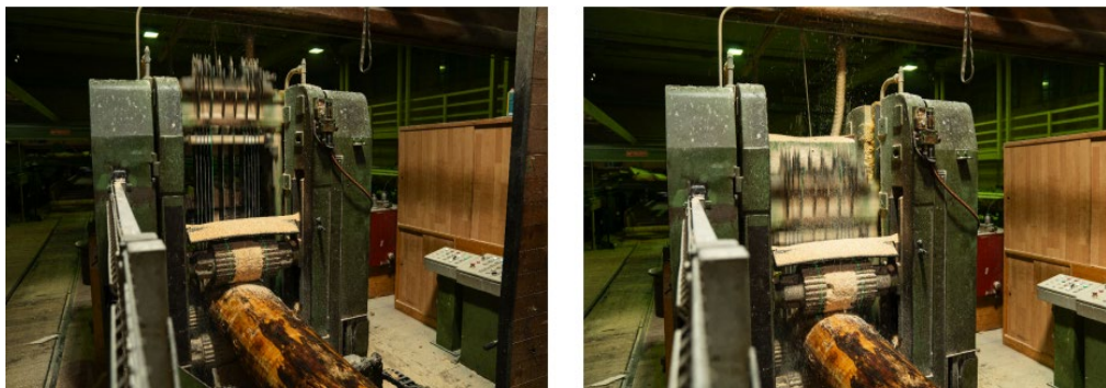
Figure 152 : Course du cadre de la scie multiple (source : Blumer Lehmann AG)
