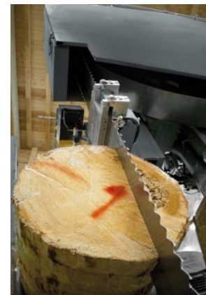
Figure 171 : Guide-lame magnétique (source : EWD)
