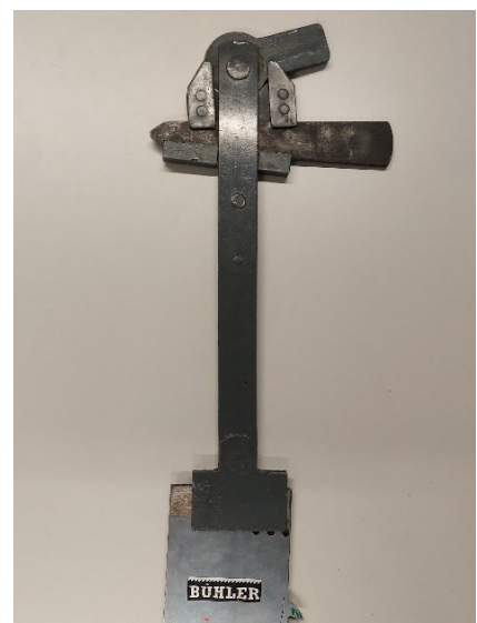
Abbildung 153: Angel mit Sägeblatt und Keilen (Quelle: S. Codourey)
