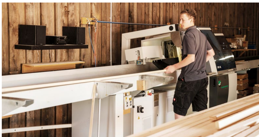
Figure 102 : Scie à tronçonner avec lame en dessous de la table (source : Lang Sägewerk AG)
