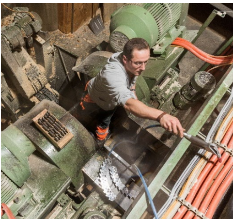
Abbildung 148: Werkzeugwechsel Spanerscheibe (Quelle: Blumer Lehmann AG)
