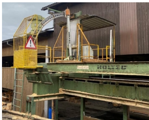
Figure 106 : Tronçonneuse à paquets (source : Schilliger Holz AG)
