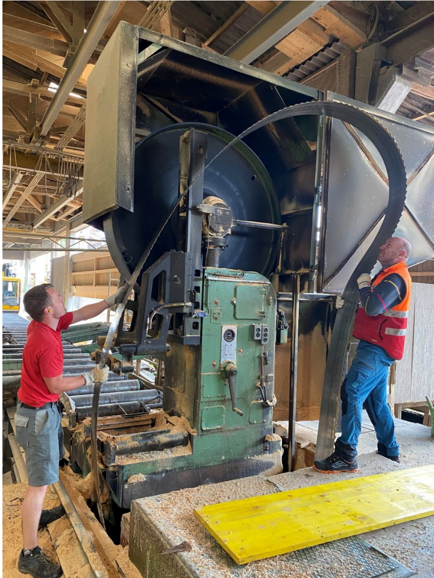
Abbildung 168: Sägeblattwechsel (Quelle: Schilliger Holz AG)
