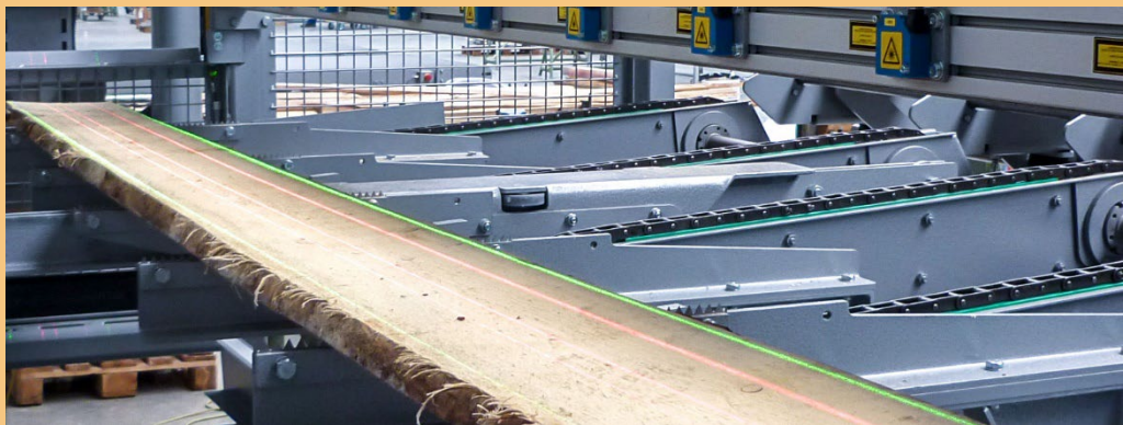
Figure 50 : Planche à déligner (Source : Paul Maschinenfabrik GmbH & Co. KG)
