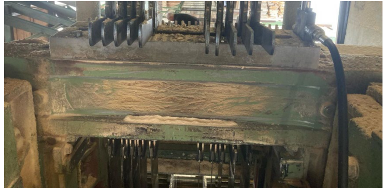
Figure 155 : Traverse supérieure du cadre avec chape (source: Yerly Bois SA)
