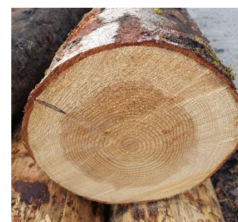
Figure 129 : Nodosité, roulure, cœur humide (source : Schilliger Holz AG, Scierie Codourey SA)
