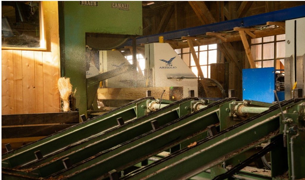
Figure 160 : Débitage sur une scie à ruban verticale (source : Scierie SYB Sàrl)
