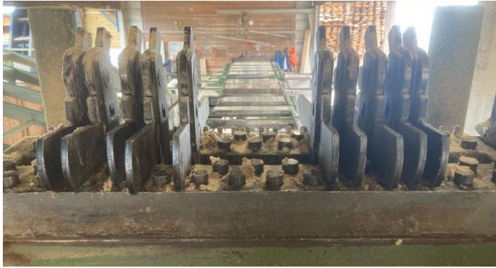
Abbildung 155: Sägeblattangeln und Keile (Quelle: Yerly Bois SA)
