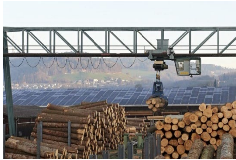
Figure 192 : Système de transport au sol et système de transport suspendu (source : Blumer Lehmann AG et OLWO AG)
