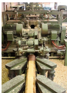
Figure 181 : Ligne de profilage (source : Schilliger Holz AG)
