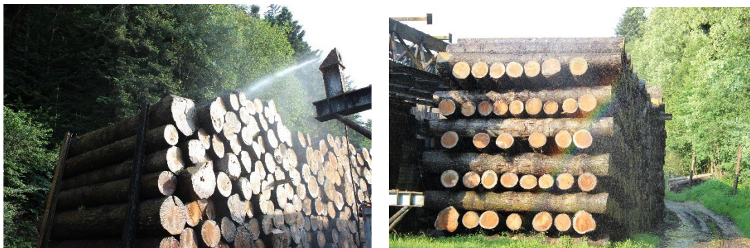
Figure 143 : Stockage en eau (source : Lerchholz Sägewerk + Kistenfabrik AG)
