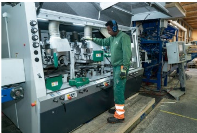
Figure 43 : Raboteuse quatre faces (source : Ruedersäge AG)
