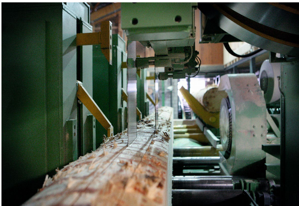
Figure 173 : Scie à ruban tandem (source : OLWO AG)
