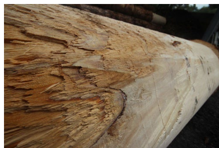
Figure 144 : Pourriture rouge et pourriture brune (source : Schilliger Holz AG)
