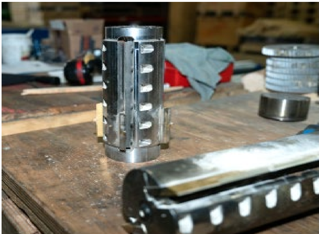
Abbildung 45: Hobelkopf (Quelle: Ruedersäge AG)
