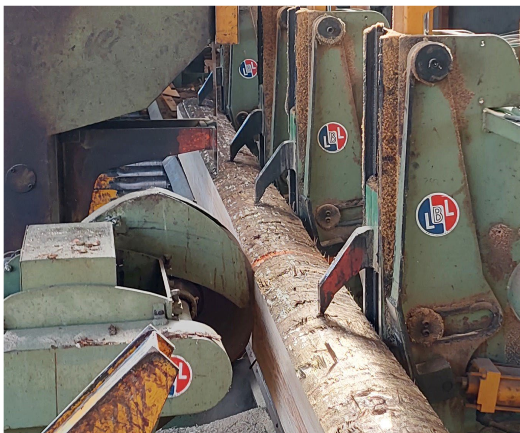
Figure 107 : Tronçonneuse pour assortiments de bord (source : Scierie Codourey SA)
