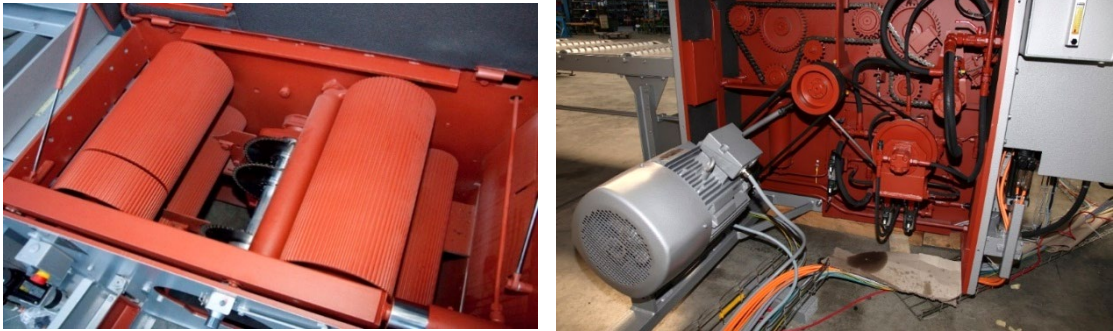
Abbildung 90: Detail Oberwalzen und Antrieb Doppelbesäumkreissäge KME2 (Quelle: Paul Maschinen Fabrik GmbH & Co. KG)
