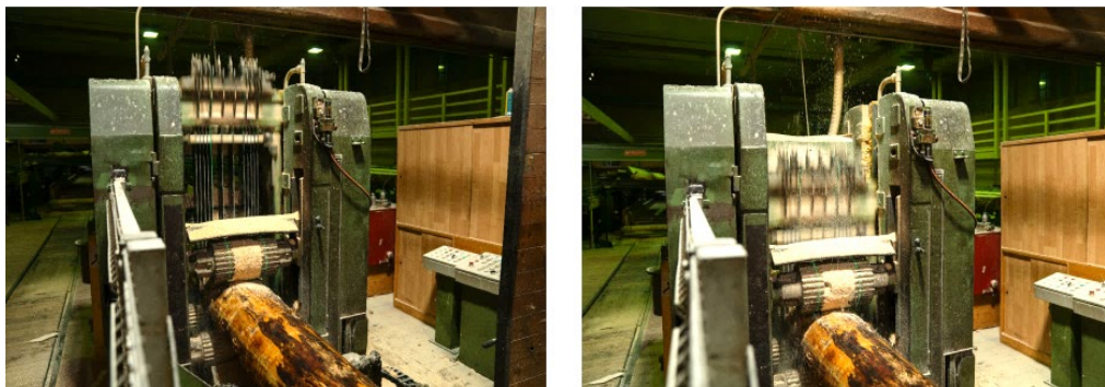
Abbildung 152: Hub des Sägerahmens (Quelle: Blumer Lehmann AG)
