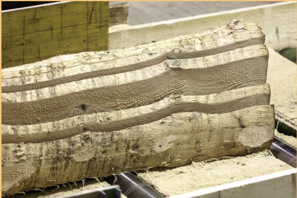
Abbildung 108: Eingeschnittenes Rundholz (Quelle: Blumer Lehmann AG)
