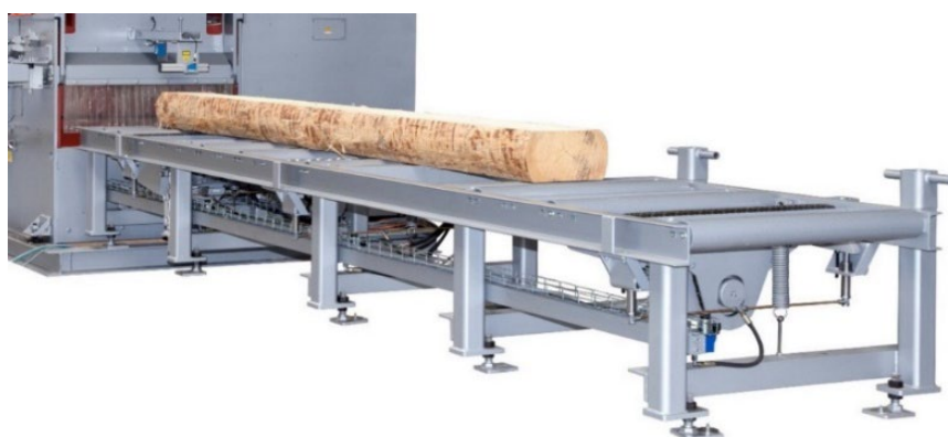
Figure 96 : Alimentation manuelle (source : Paul Maschinen Fabrik GmbH & Co. KG)
