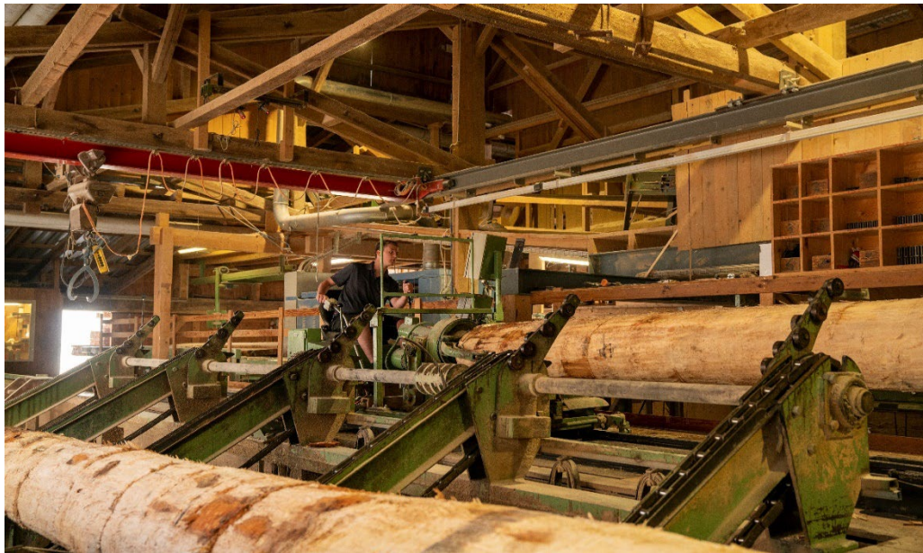
Figure 159 : Alimentation en grumes d'une scie multiple (Source : Lang Sägewerk AG)
