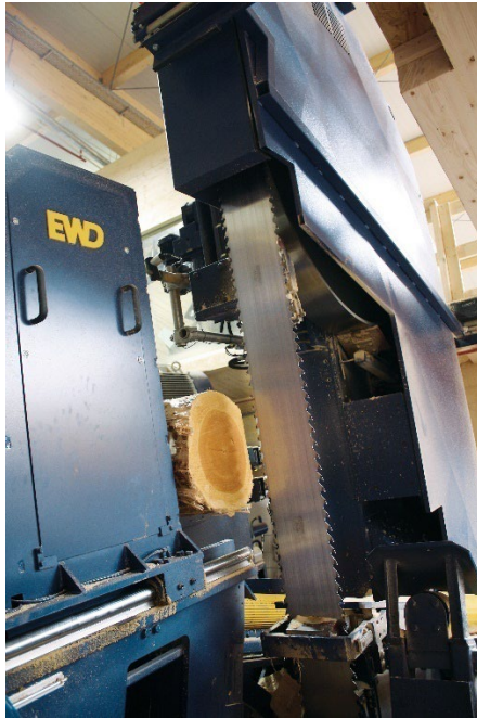
Figure 163 : Scie à ruban verticale (source : EWD)
