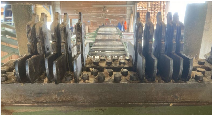
Figure 154 : Dispositif de tension hydraulique Jansen avec prétension par excentrique (source: Yerly Bois SA)
