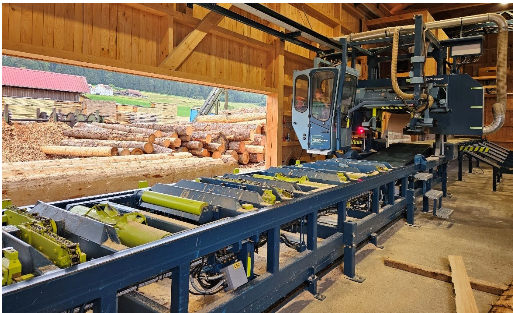
Figure 165 : Scie à ruban horizontale (source : Ingold Holz AG)
