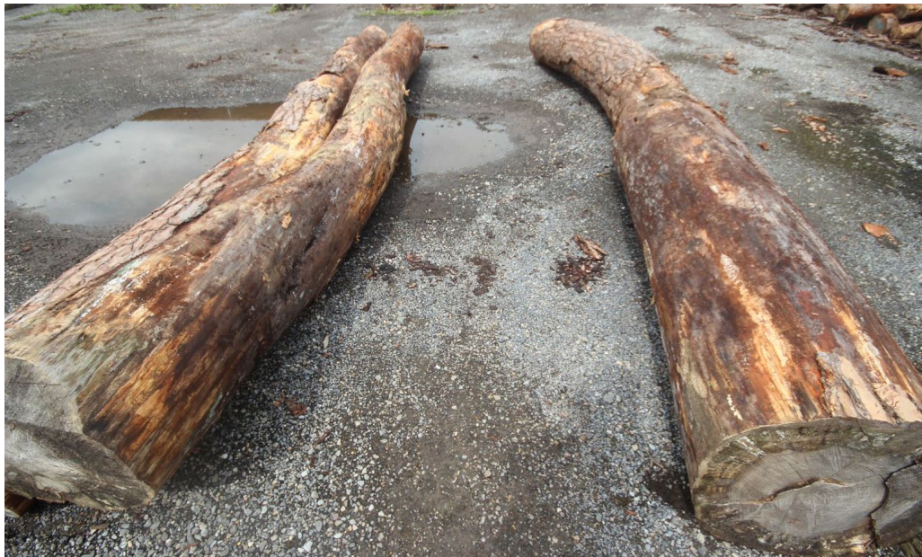
Abbildung 116: Gabel-/Zwieselwuchs, Krummschaftigkeit und Abholzigkeit (Quelle: Schilliger Holz AG)
