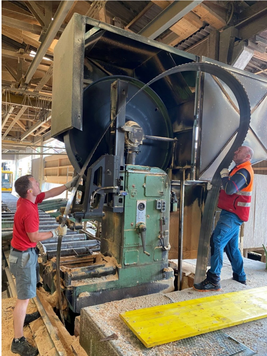
Figure 168 : Changement de ruban (source : Schilliger Holz AG)
