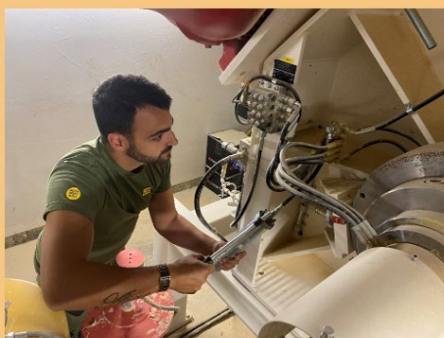
Figure 1 : Nettoyage et lubrification (source : OLWO)
