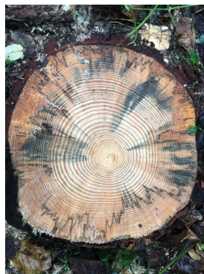
Figure 145 : Bleuissement d'un pin (source : WSL)
