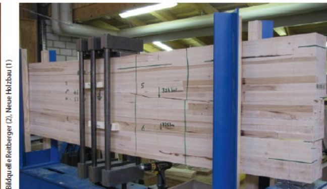
Im hausInternen Labor werden die Produkteigenschaften ganzer Leimbinder (Bild: BSH-Buche, GL48k) oder einzelner Lamellen überprüft und verbessert
