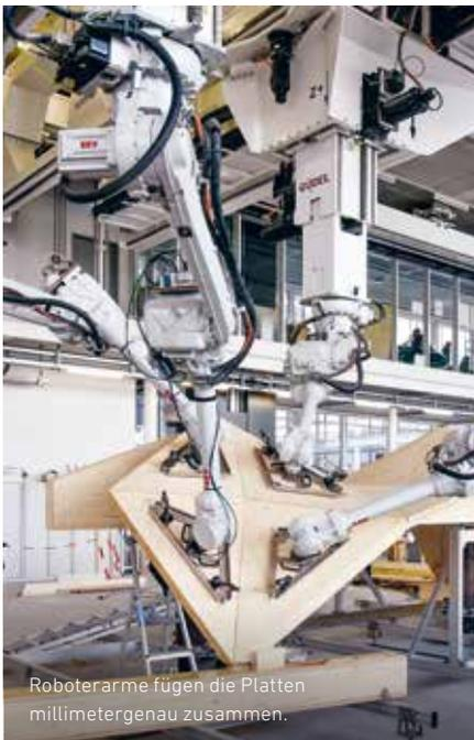
Roboterarme fügen die Platten millimetergenau zusammen.
