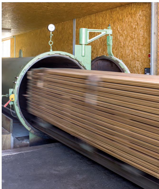
Autoklav zur Druckimprägnierung
