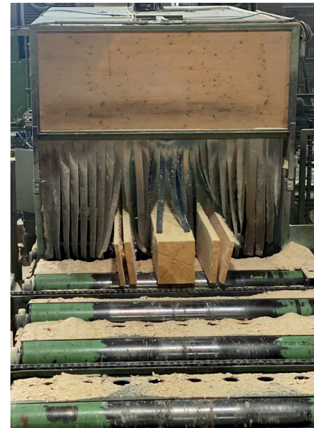
↑ Au cœur de la production : la ligne de canter.
