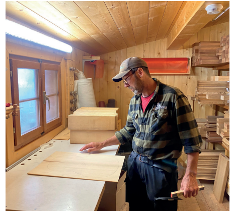
↑ Andrea Florinett contrôle un gabarit d'instrument. Les contours du corps de l'instrument sont reportés directement sur le bois de résonance.
