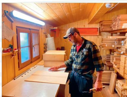
Andrea Florinett prüft eine Instrumentenschablone. Die Umrisse der Instrumentenkörper werden direkt auf das Resonanzholz übertragen.
